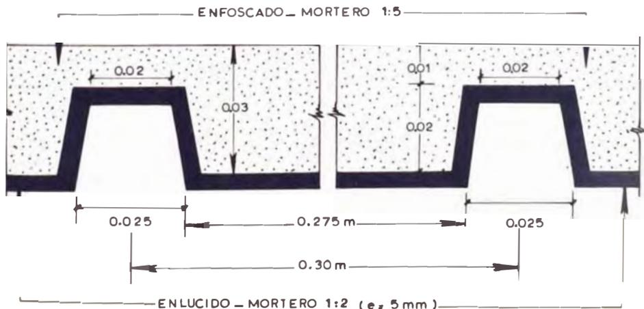
FIG.29 TARRAJEO ACANALADO EN MUROS EXT.(Tiendas)
