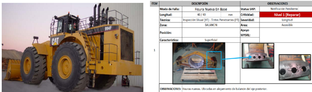
Figura N° 31 Cargador frontal y detalle de fisura detectada en componente
