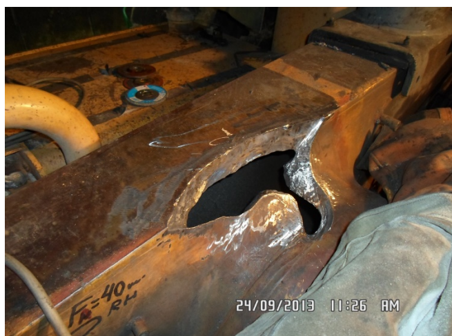
Figura N° 42 Reconstrucción en riel central de chasis de camion 793C por efecto de multiples reparaciones en la zona.
