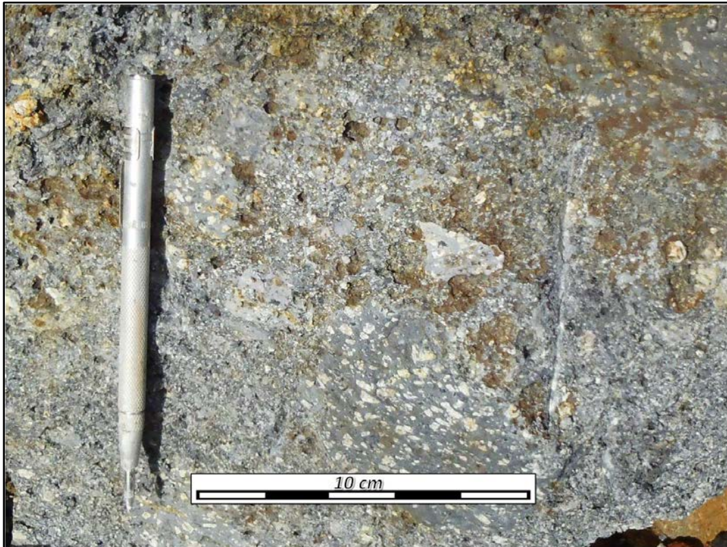
Foto 1-Roca de fragmental monolítica, con fragmentos de roca > 1 cm de textura porfirítica media con feldespatos en matriz afanítica se encuentran en matriz gris clara fina y con desarrollo de Cloritas.
