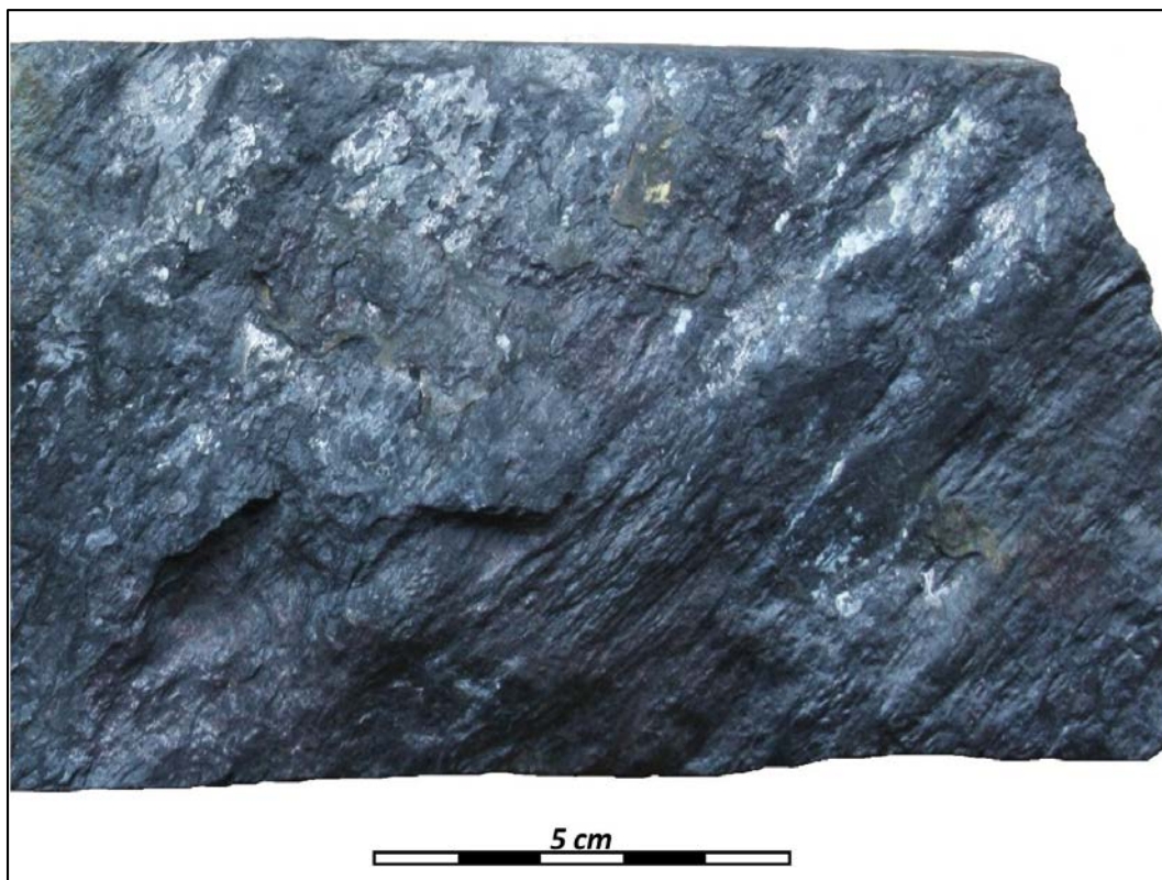
Foto 14-Roca de textura clásica fina carbonacea afectada por fuerte tectonismo (falla Cassador), mostrando los superficie de falla (Grafito) y estrías de falla.
