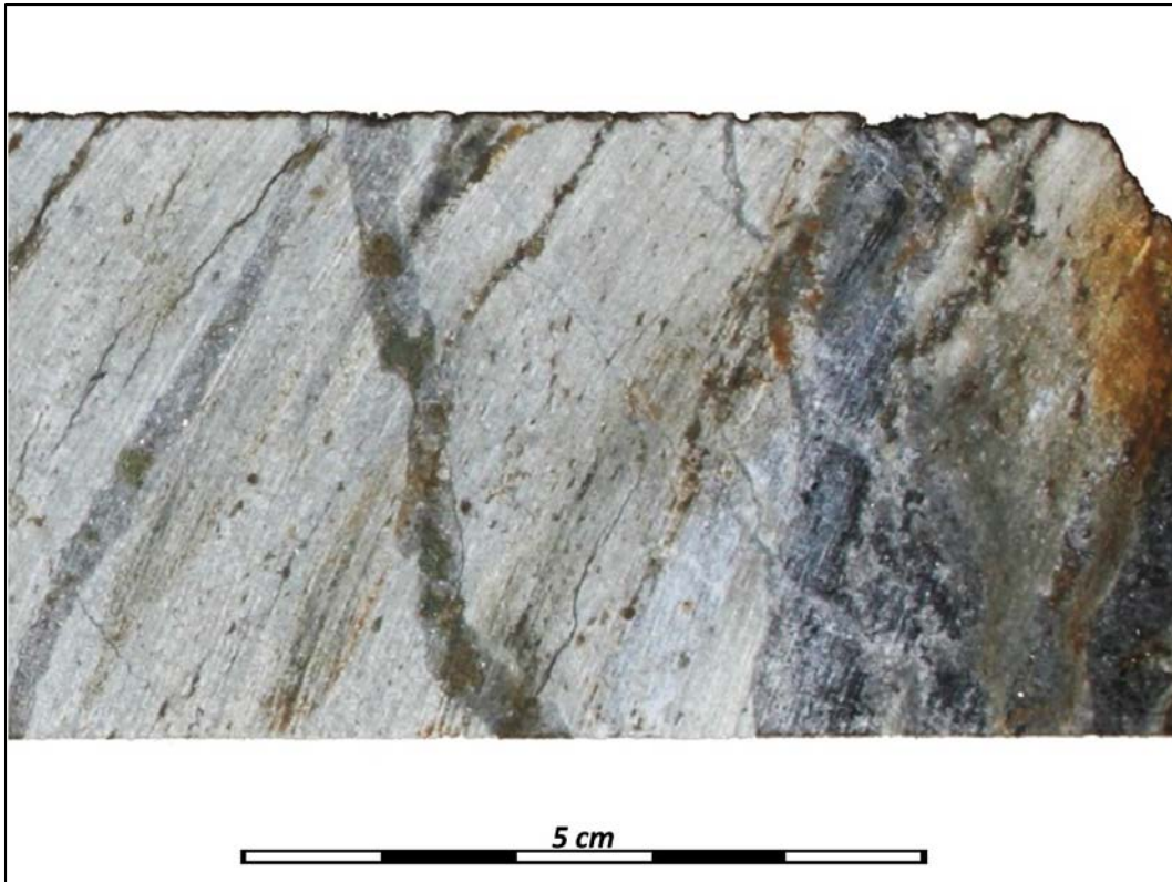
Foto 17-Roca de textura volcánica fina (Esquistos verdes), presenta clorita-sericita y Po (5%)-Py(3-5%)-Apy(1%) diseminada, cortada por venillas de Cuarzo-Ca-Py.
