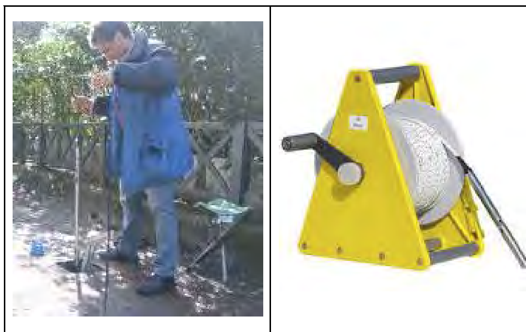
Figura 0.14 Introducción del torpedo en el tubo inclinométrico y sonda piezométrica
