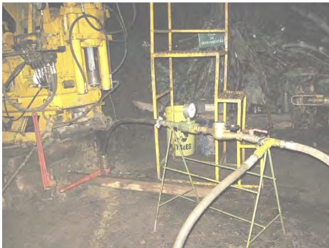
Figura 0.7 Ensayo de Lefranc “in situ” en el hoyo del sondeo diamantino
