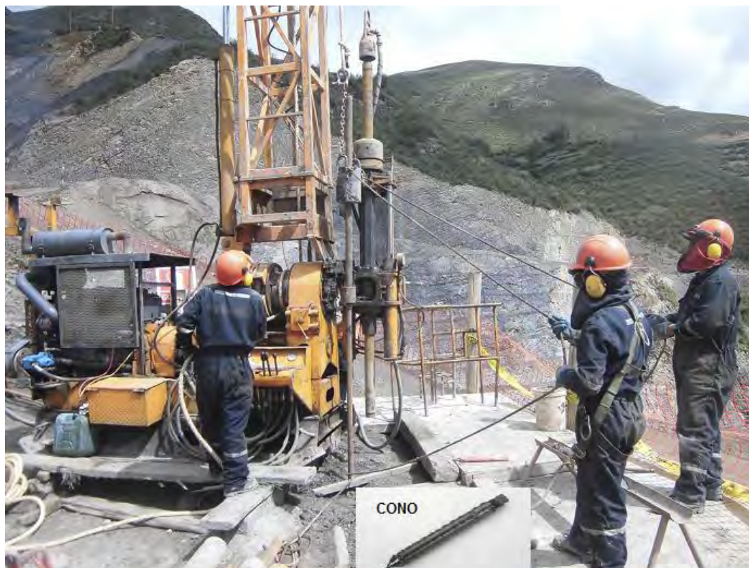
Figura 0.8 Ensayo del cono de Peck en un sondeo de perforación
