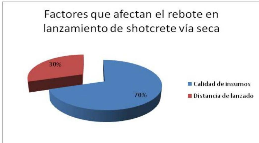
**FIGURA N° 18: Factores que afectan el lanzamiento del shotcrete vía seca**
