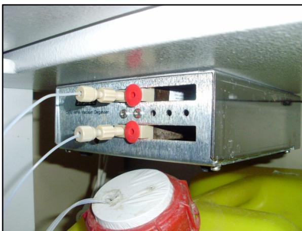
Fig. 4.09 Desgasificador y capilar de Carbonato de sodio
