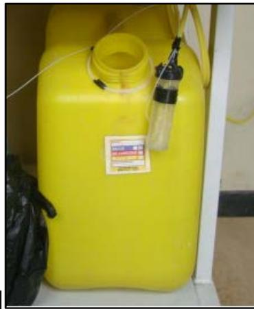
Fig. 4.07 Recipiente de muestra, capilar de ingreso y depósito de rechazo
