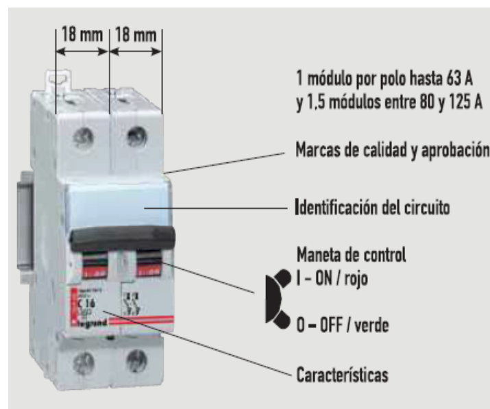
Fig. 3.17 : Interruptor riel DIN DX 3 6000 - LEGRAND
