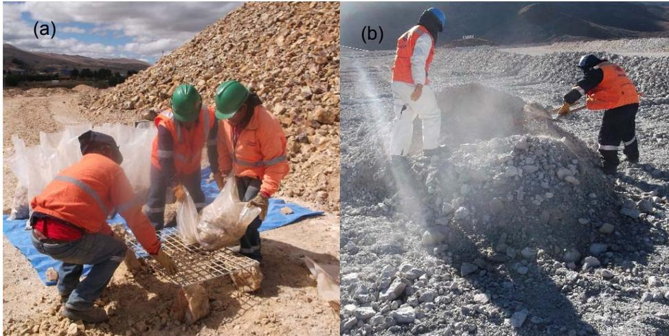
Figura N° 4.1. Fotografía del material granular obtenido por voladura "A" y obtenido por chancado "B" ensayado en campo (a) y (b), respectivamente.
