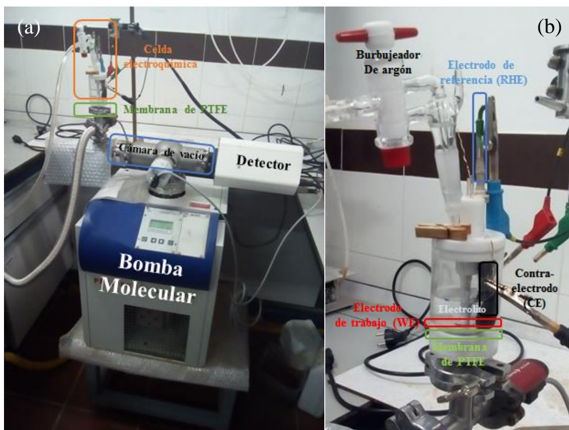
Figura 30: (a) Espectrómetro DEMS y sus componentes. (b) Celda electroquímica DEMS utilizada en el estudio de los electrocatalizadores soportados de Ni y NiCo aplicados a la reacción HER.
