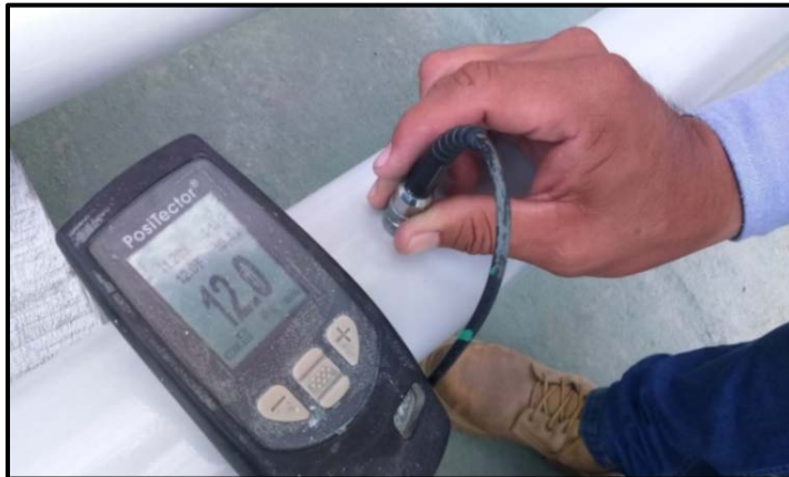
Figura 14: Medición de espesor de película seca en tuberías. Fuente: Elaboración Propia.
