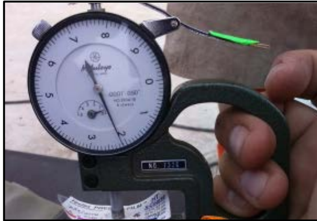
Figura 10: Medición del perfil de rugosidad.
