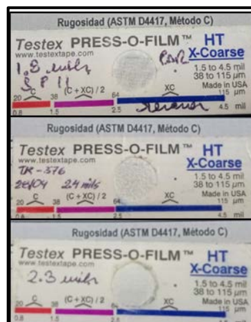
Figura 29: Valores de perfil de rugosidad obtenidos en la obra, mediante el uso del método C (cintas réplicas).
