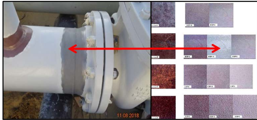
Figura 28: Uso de la guía de referencia fotográfica SSPC-VIS1 como complemento a la inspección según norma SSPC-SP10.
