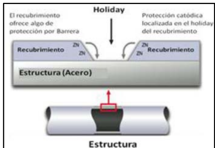
Figura 36: Efecto de protección catódica.
