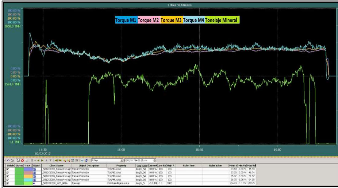
Fig. 4.16 Curvas de % de torque de motores de faja a 2500 tmh [Fuente: Propia, Foto tomada durante la ejecución del proyecto]
