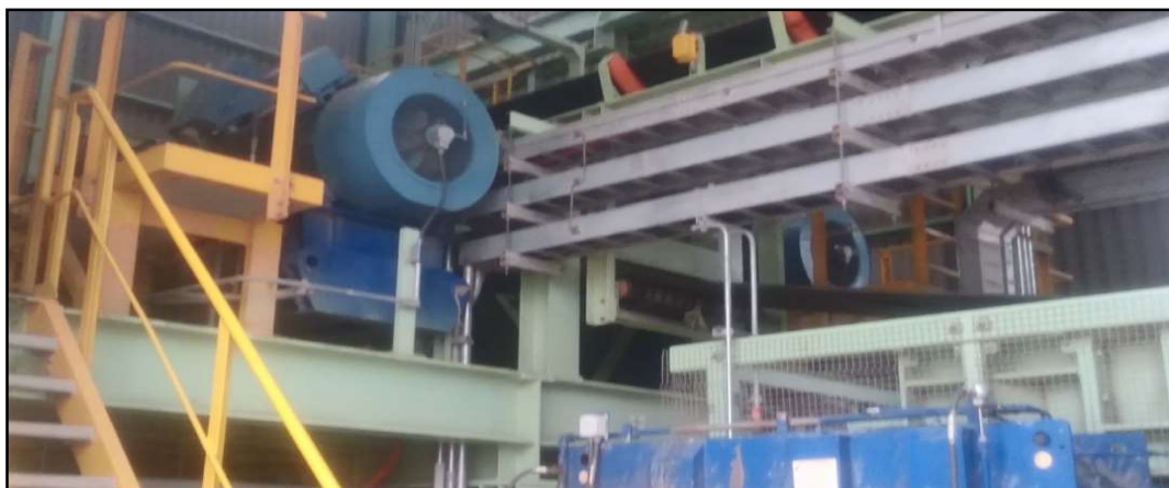
Fig. 3.3 Motores de lado cabeza de faja [Fuente: Propia, Foto tomada durante la ejecución del proyecto]
