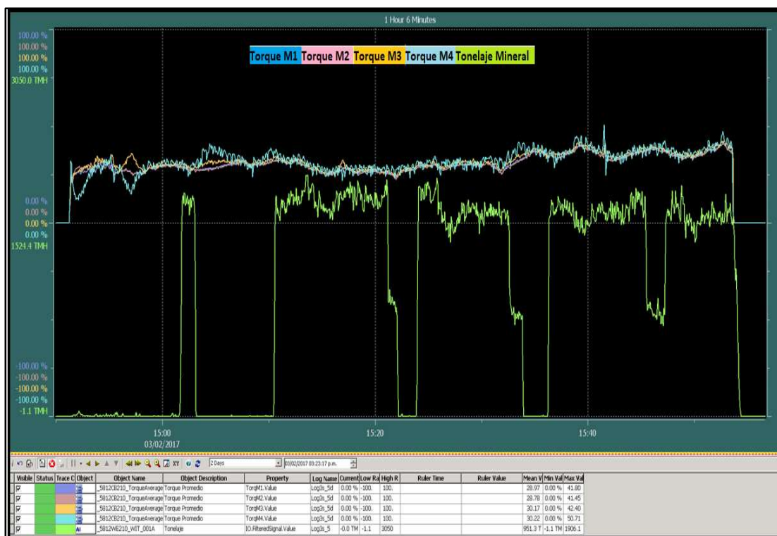
Fig. 4.15 Curvas de % de torque de motores de faja a 1800 tmh [Fuente: Propia, Foto tomada durante la ejecución del proyecto]
