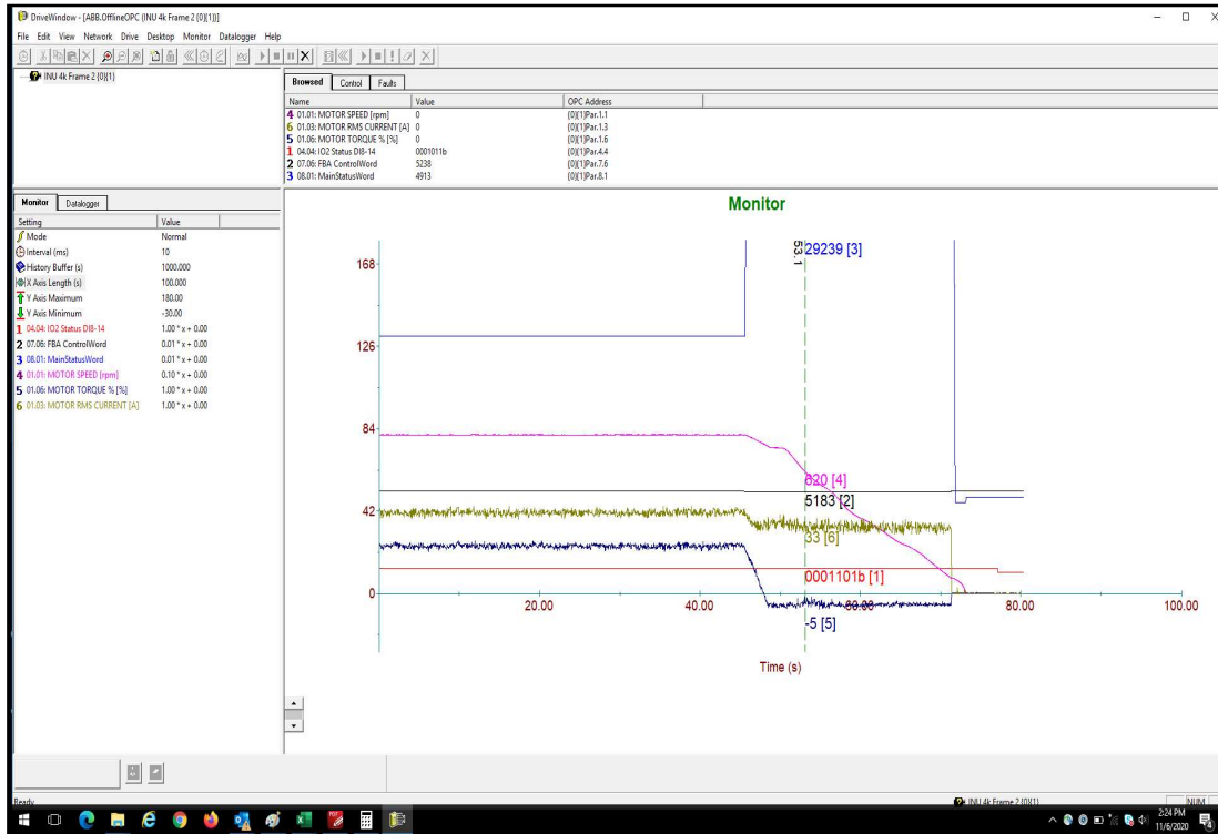
Fig. 4.13 Curvas de % de torque (Azul), corriente(amarillo) y velocidad(rosado) de motor M4 acoplado a faja [Fuente: Propia, registro en software de monitoreo, durante la puesta en marcha]
