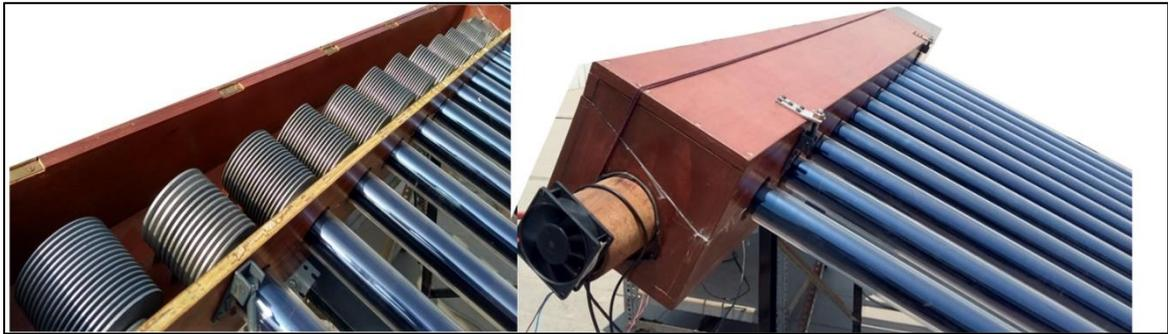
Figura 27. Disposición de los dissipadores anulares de aluminio y el ventilador.
