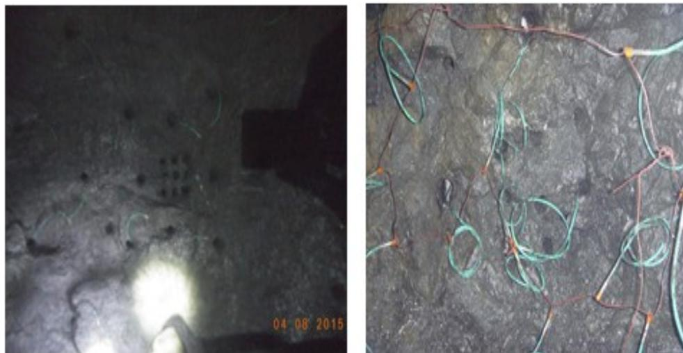
Figura N° 9.3: Muestra la perforacion y conexión de los taladros en el fronton.
