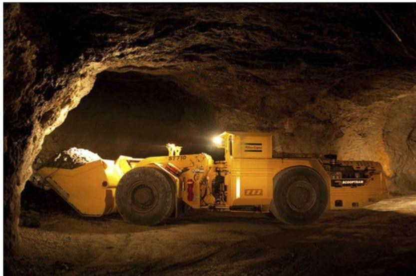
Figura N° 7.4: Muestra un scoop en pleno trabajo.
