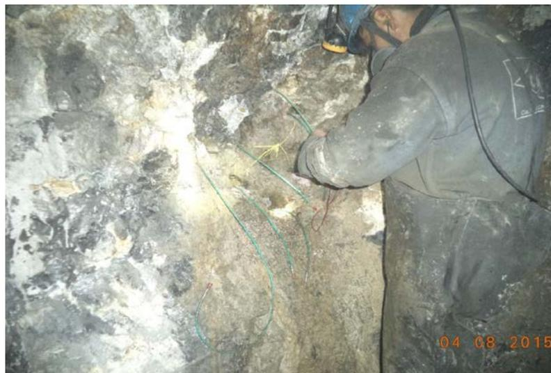
Figura N° 5.7: Muestra la conexión de los taladros.
