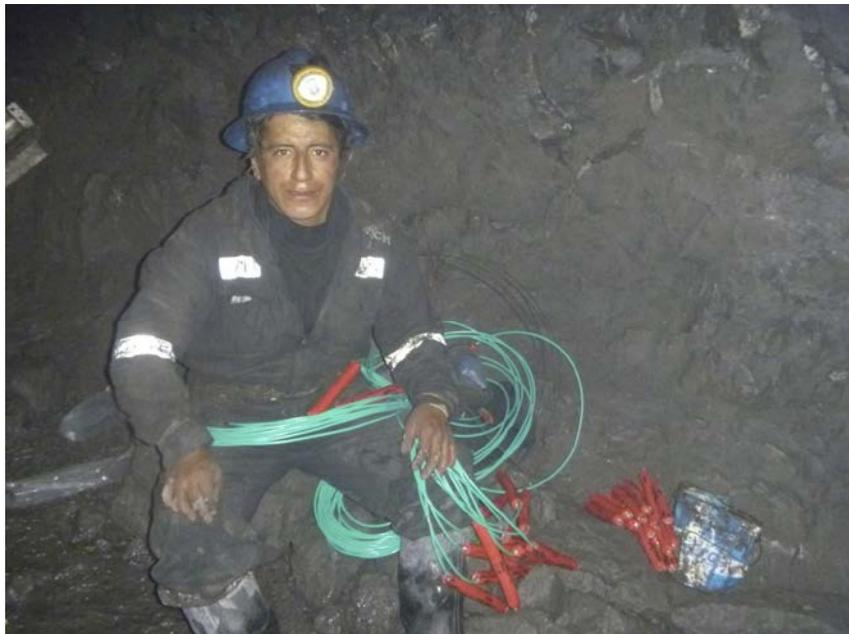
Figura N° 5.8: Muestra el cebado de los primer listos para ser cargados.
