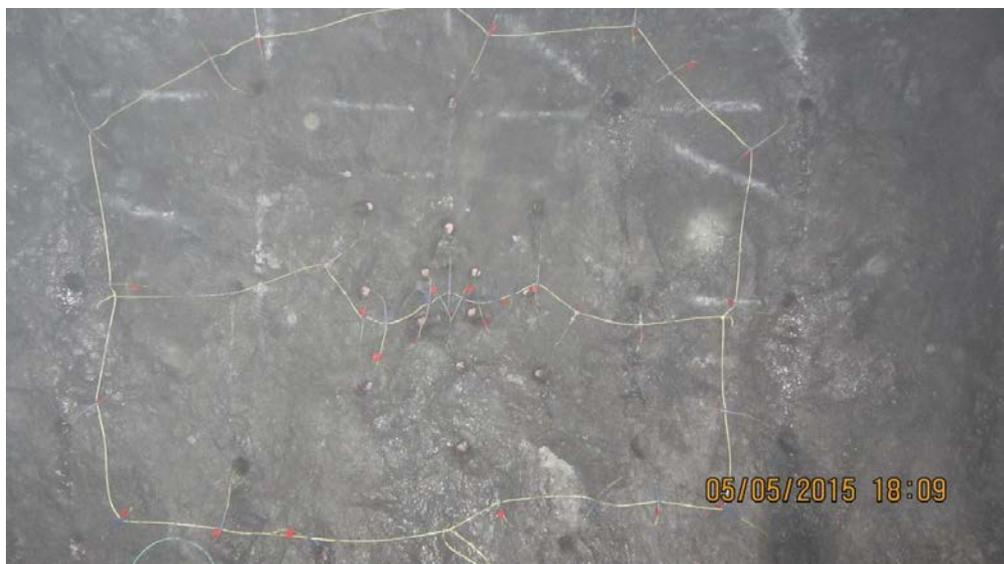
Figura N° 6.6: Muestra el frontón conectado en la UEA Los Chunchos.
