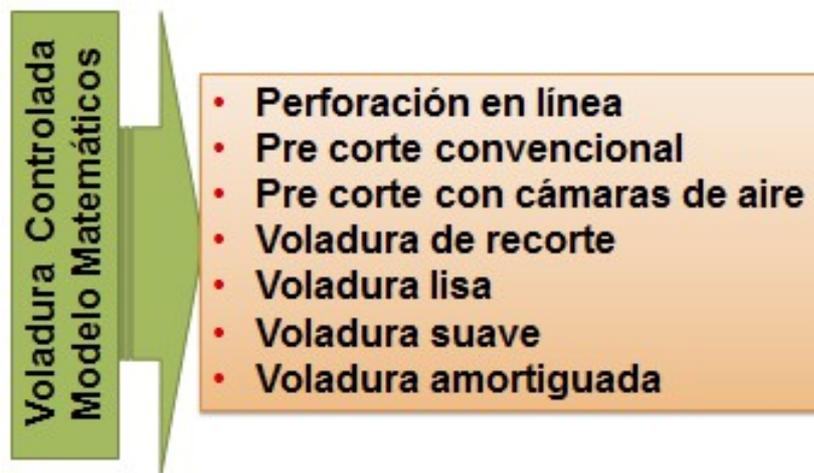
Figura N° 6.5: Muestra los modelos matemáticos que usa la voladura controlada.
