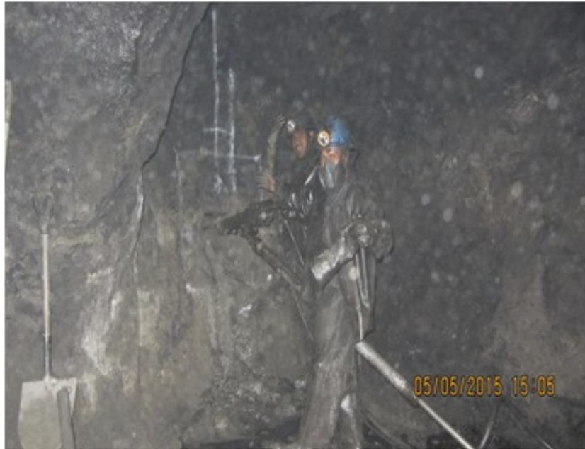
Figura N° 9.2: Muestra la perforacion del fronton.
