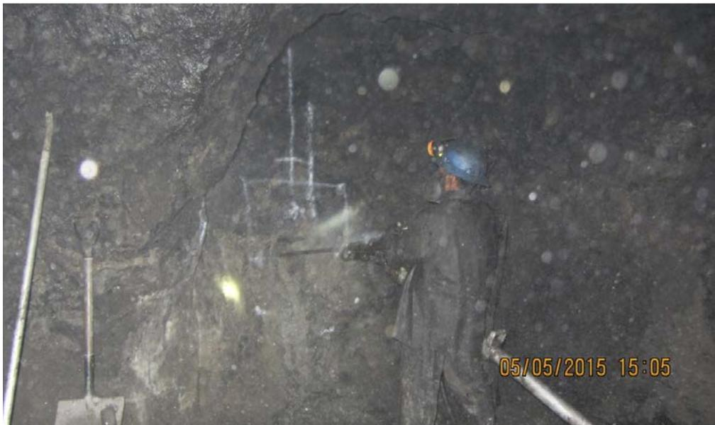
Figura N° 7.3: Muestra la perforación de un frontón en la UEA Los Chunchos.
