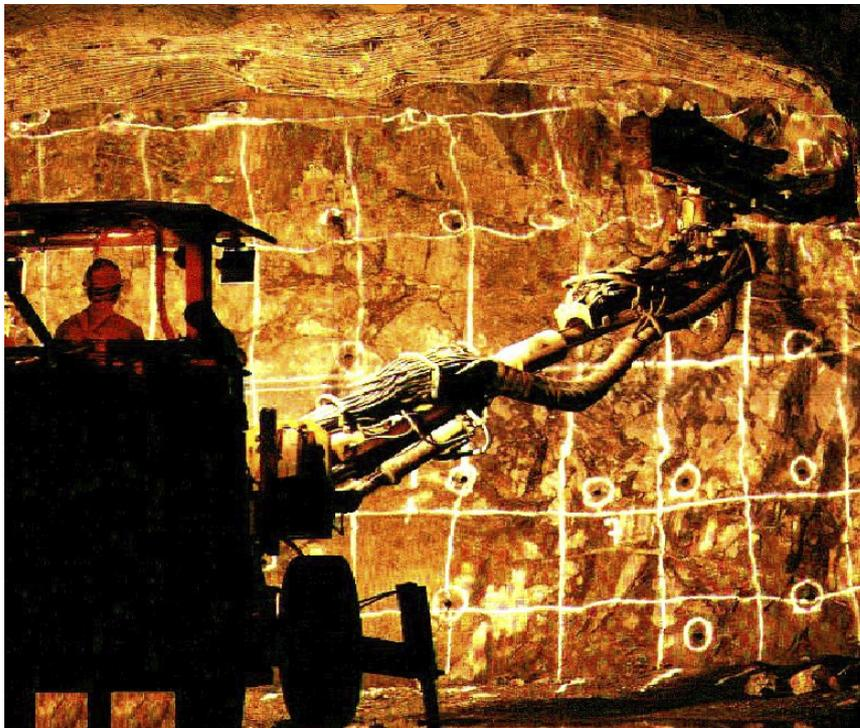
Figura N° 7.2: Muestra el jumbo en pleno trabajo de perforación.
