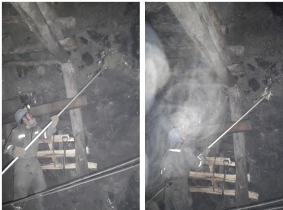
Figura N° 8.1: Muestra el sostenimiento con madera en al UEA Los Chunchos.
