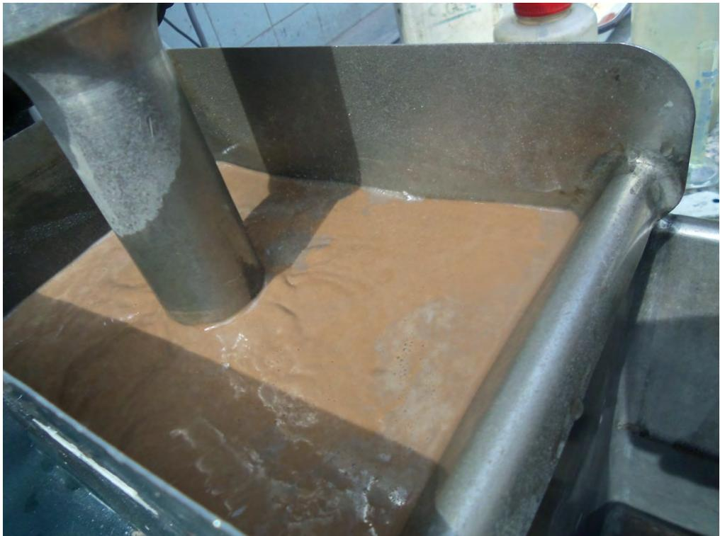
**Fotografía 2.- Acondicionamiento de la flotación Rougher –Sulfuros**
