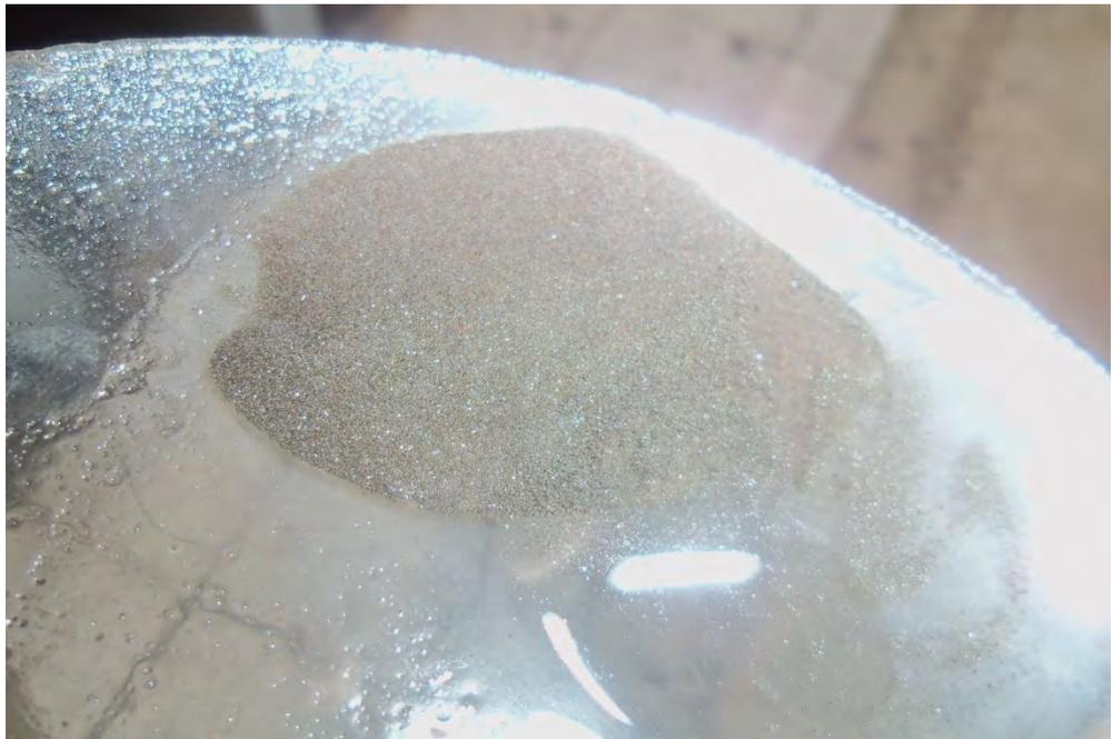
**Fotografía 12.- Concentrado de la flotación Cleaner II**
