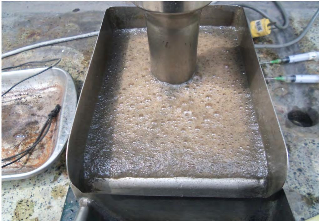
**Fotografía 8.- Espumas de la flotación Cleaner I**
