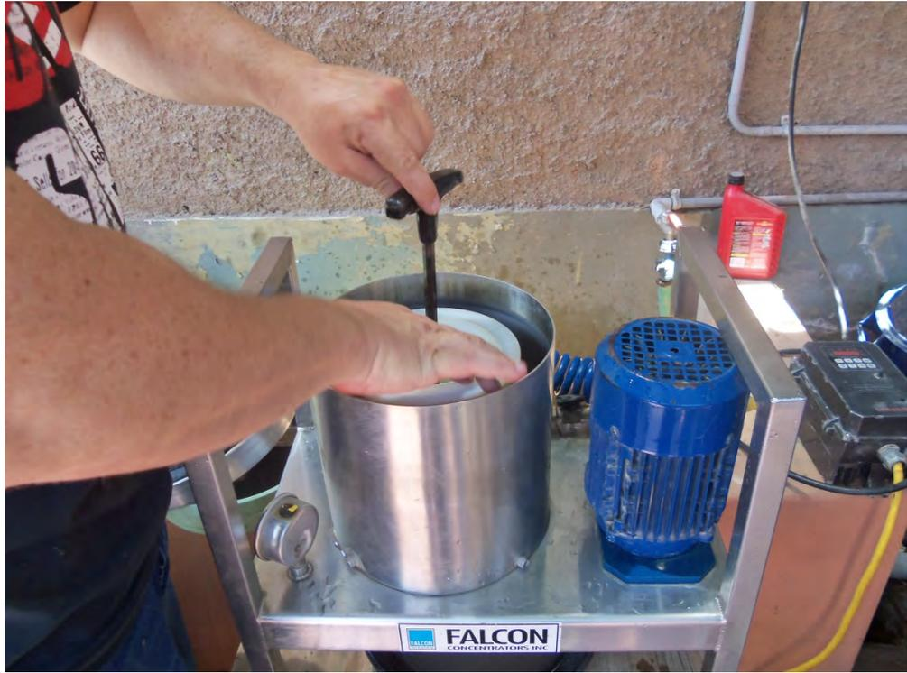
**Fotografía 3.- Partes del Concentrador Gravimétrico Falcón**
