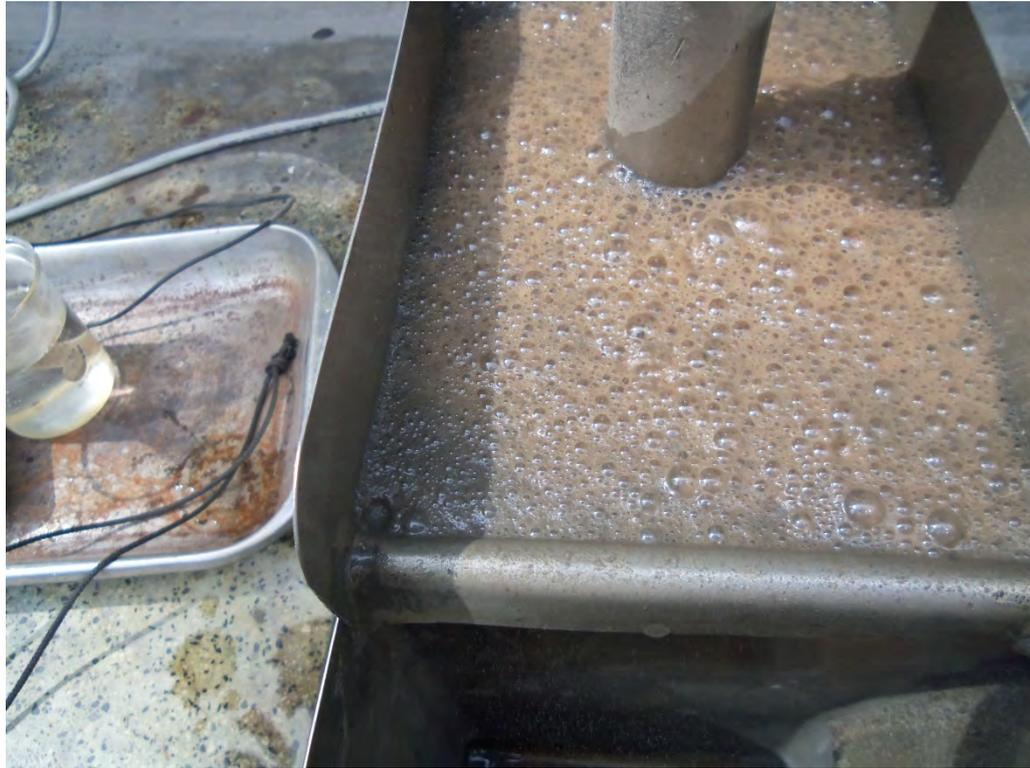
**Fotografía 3.- Espumas de la flotación Rougher –Sulfuros**
