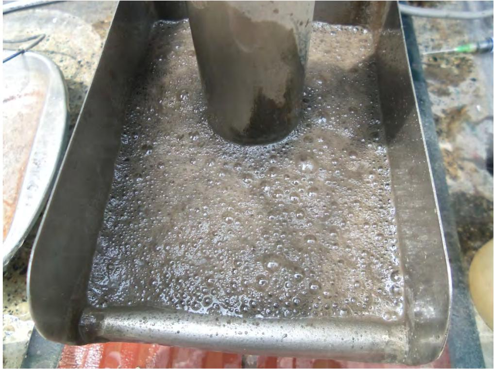
**Fotografía 9.- Espumas de la flotación Cleaner II**
