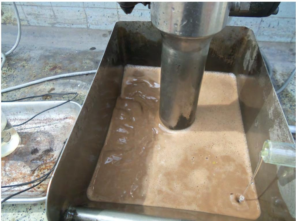
**Fotografía 6.- Acondicionamiento de la flotación Scavenger –Oxidos**
