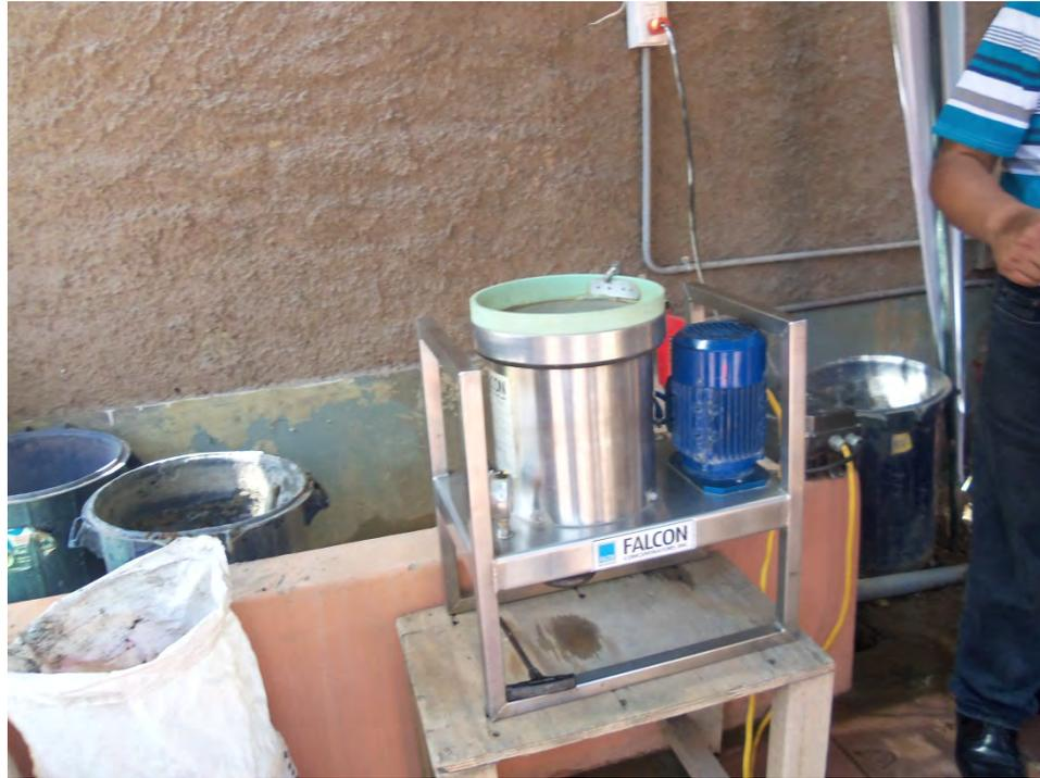
**Fotografía 1.- Concentrador Gravimétrico Falcón de Laboratorio**
