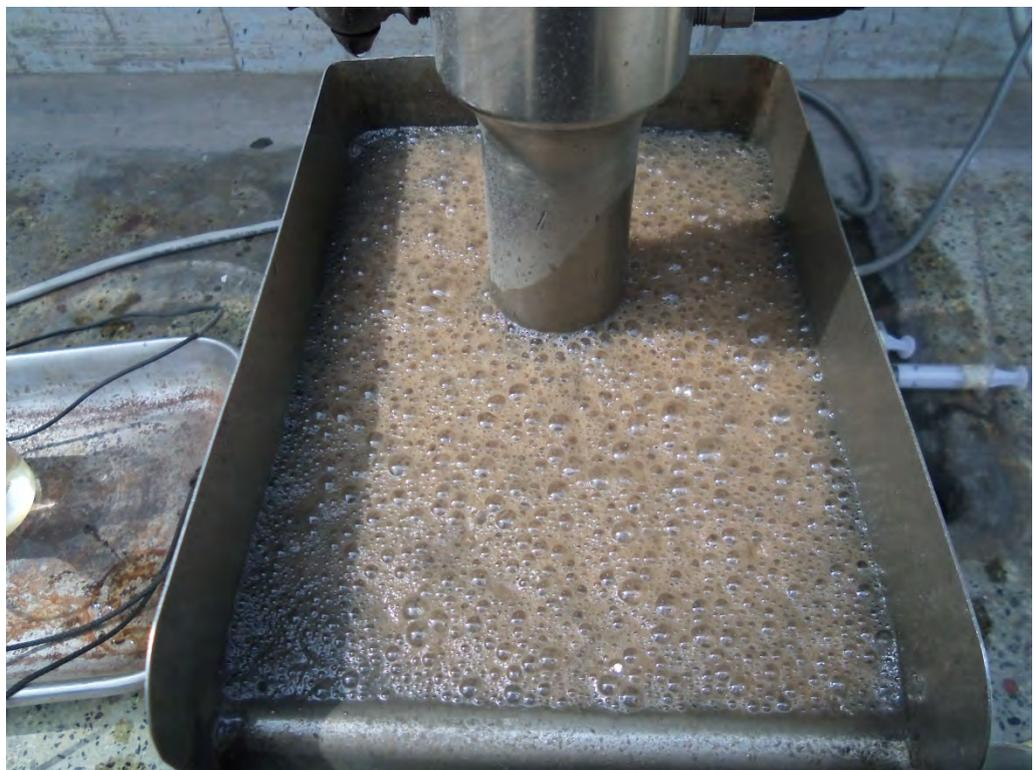
**Fotografía 4.- Espumas de la flotación Rougher –Sulfuros**
