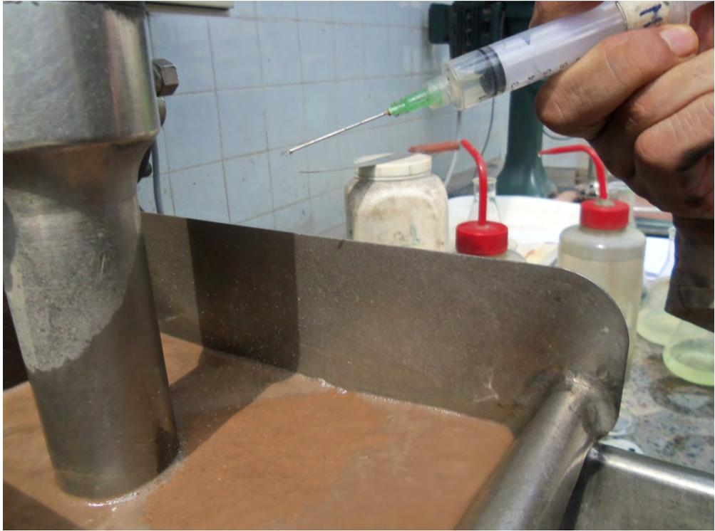
**Fotografía 1.- Acondicionamiento de la flotación Rougher -Sulfuros**
