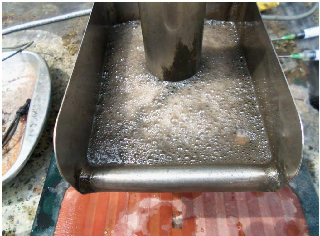
**Fotografía 10.- Espumas de la flotación Cleaner II**
