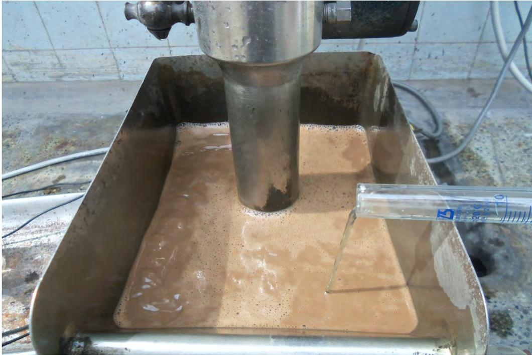
**Fotografía 5.- Acondicionamiento de la flotación Scavenger –Oxidos**
