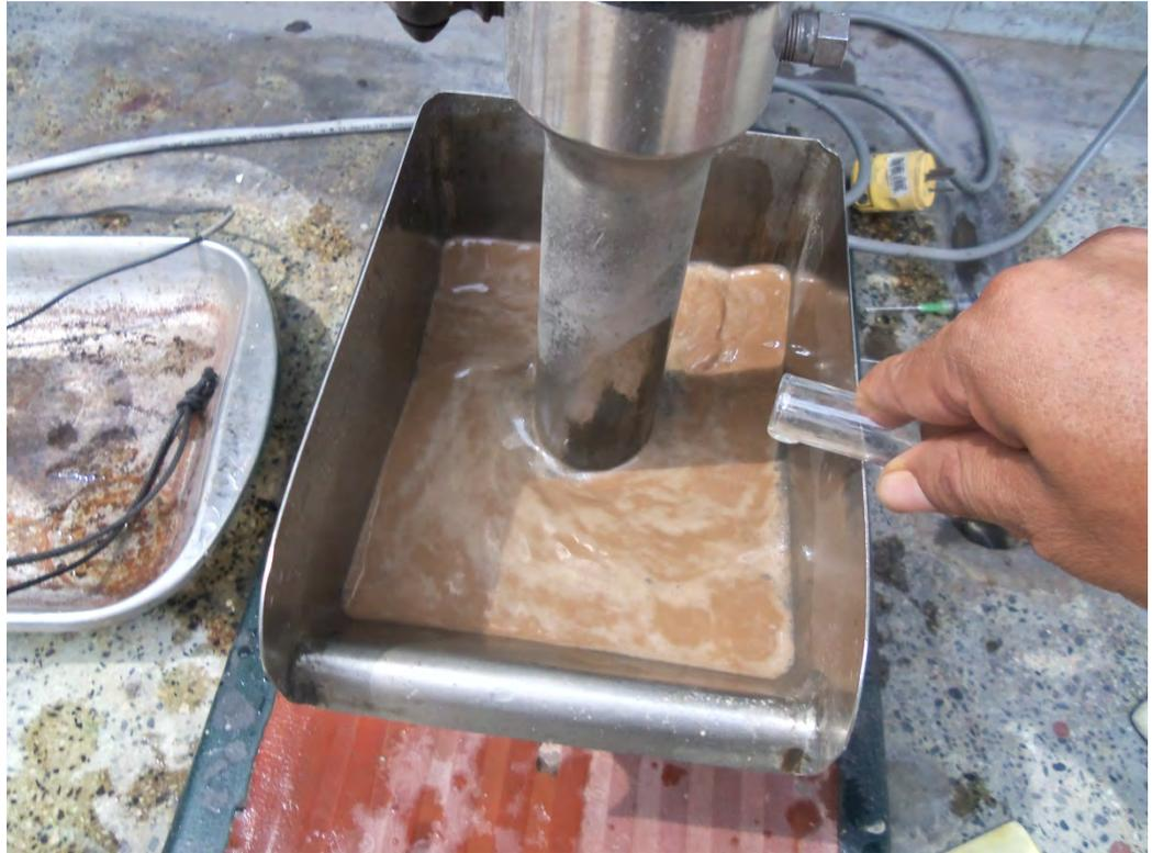
**Fotografía 7.- Acondicionamiento de la flotación Cleaner I**
