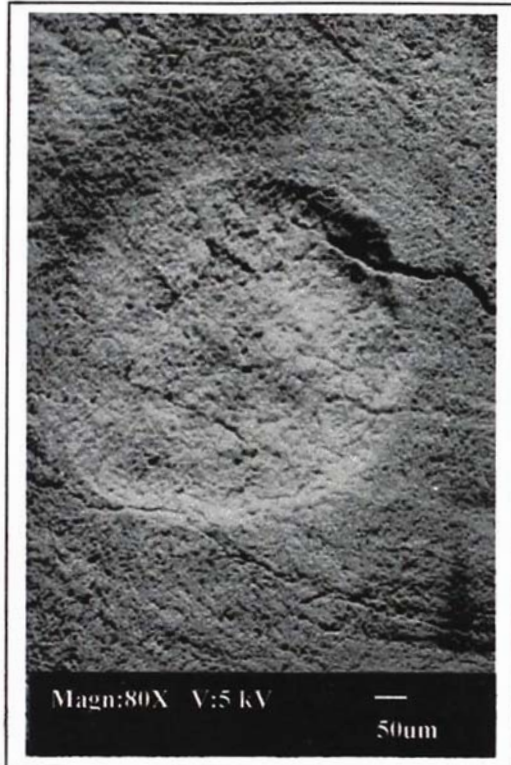
Micrografía N°1: Impacto del rayo láser sobre el esmalte.
