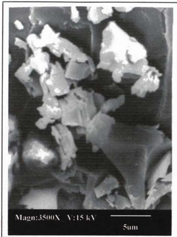
Micrografía N°3 Partículas angulosas (probablemente Cuarzo) menores a 10 um.
