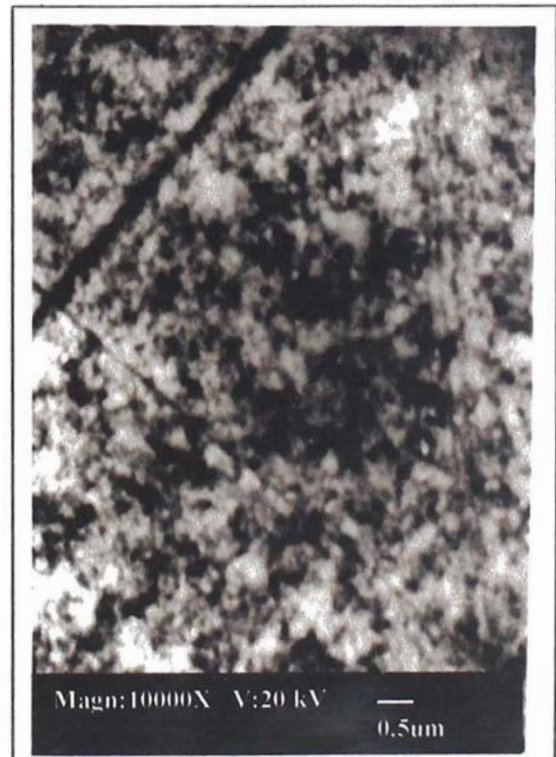
Micrografía N°4 Las partículas son menores a 100 nm.
