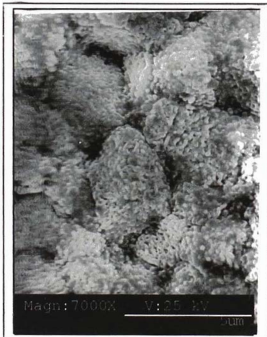
Micrografía N°3. El material se encuentra depositado uniformemente sobre la superficie de Oro.
