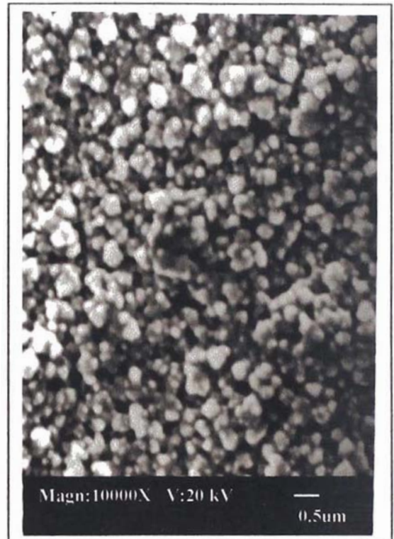
Micrografía N°2 Partículas de alrededor de 500 nm.
