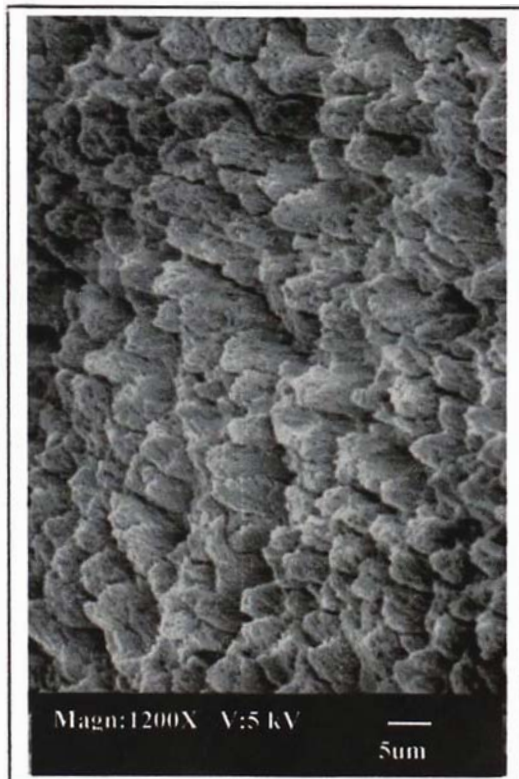
Micrografía N°3: Las partículas son alargadas y están orientadas.
