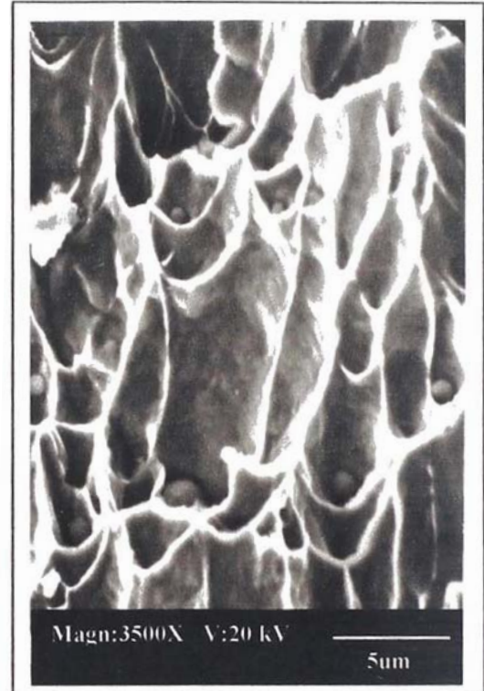
Micrografía N°2 Dentro de los lóbulos se hallan pequeñas esferas de aproximadamente 1µm.
