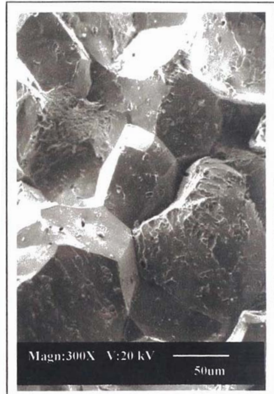
Micrografía N°6 Forma tridimensional de los granos que conforman el acero.
