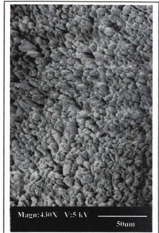
Micrografía N°2: Arreglo de partículas dentro de la zona de impacto.
