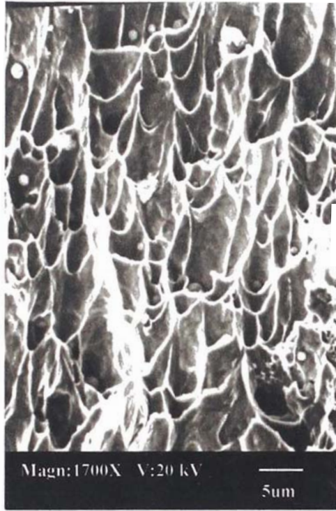
Micrografía N°1 Lóbulos elípticos cuyos bordes apuntan hacia el centro de la probeta.
