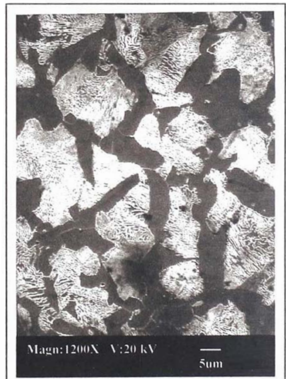
Micrografía N°1: Microestructura de un acero 1045 enfriado lentamente (figura anterior) mostrando a la Ferrita y a la Perlita.
