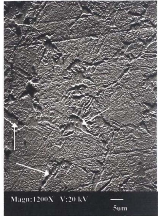
Micrografía N°4 Imagen de E.R. Microestructura de un acero 1045 enfriado como se muestra en la figura anterior; los huecos señalados por las flechas son ferritas.
