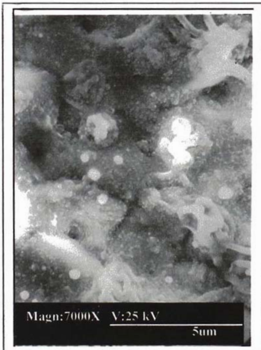
Micrografía N°19. Se observa la fase granular y la fase continua visto anteriormente, y las partículas claras (redondas) son de aproximadamente 400 nm.
