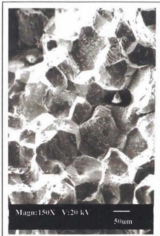
Micrografía N°5 Superficie fracturada (accidentada) característico de una fractura frágil intergranular.
