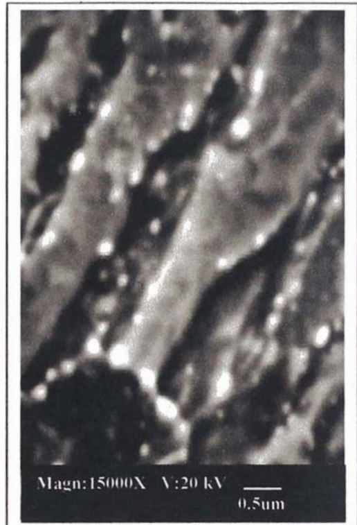
Micrografía N°9 Pequeñas partículas en los bordes de la martensita; probablemente carburos de Hierro (producto del revenido).
