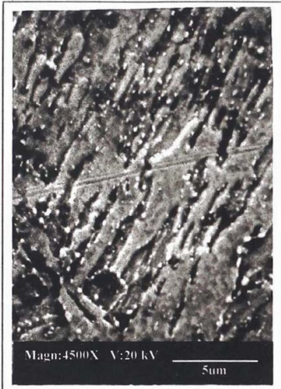
Micrografía N°8. El material apuntando en una dirección determinada característicos de la fase martensítica.
