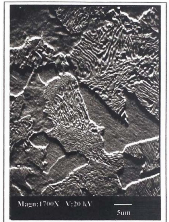
Micrografía N°3 Imagen de electrones Retrodispersados (ER), misma zona al anterior, Obsérvese que la información topográfica es mejor al anterior. La franjas de la cementita en la perlita se encuentra sobresalida.
