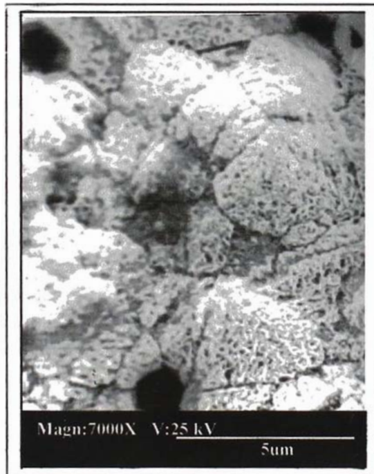
Micrografía N°7. Aparentemente existen dos fases diferentes, las claras y las grises; La estructura mas abundante es la clara (aproximadamente 90%).
