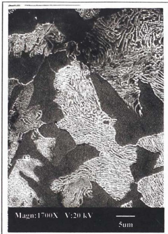
Micrografía N°2 Imagen de electrones secundarios (ES) , mostrando la forma lamelar de la perlita; las franjas claras son la cementita.
