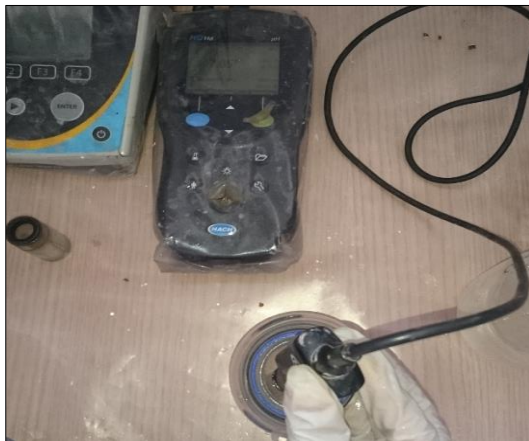
Fotografía N° 13: Lectura del pH y temperatura de la muestra con el medidor portátil HQ11d de la marca HACH.
