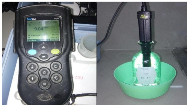
Fotografía N° 17: Medición del Oxígeno disuelto después de los cinco días en la incubadora.
