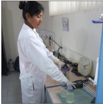
Fotografía N° 15: Medición del Oxígeno Disuelto
