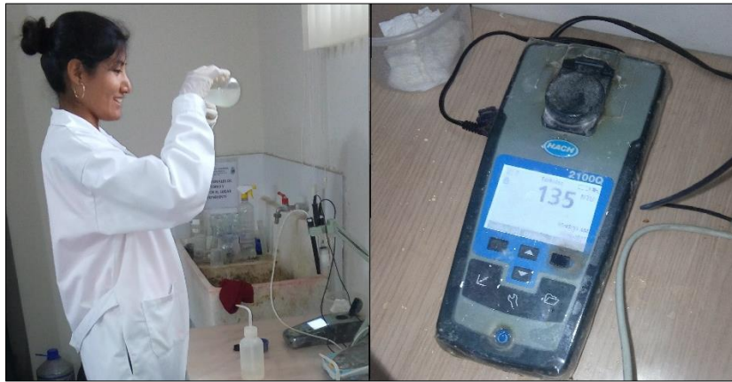
Fotografía N° 12: A la izquierda: Agregando la muestra a la celda. A la derecha: Lectura del turbidímetro
