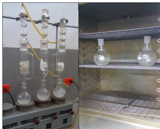
Fotografía N° 26: Equipo de extracción Shoxxlet en funcionamiento y balones de vidrio en el horno después de la destilación de hexano.
