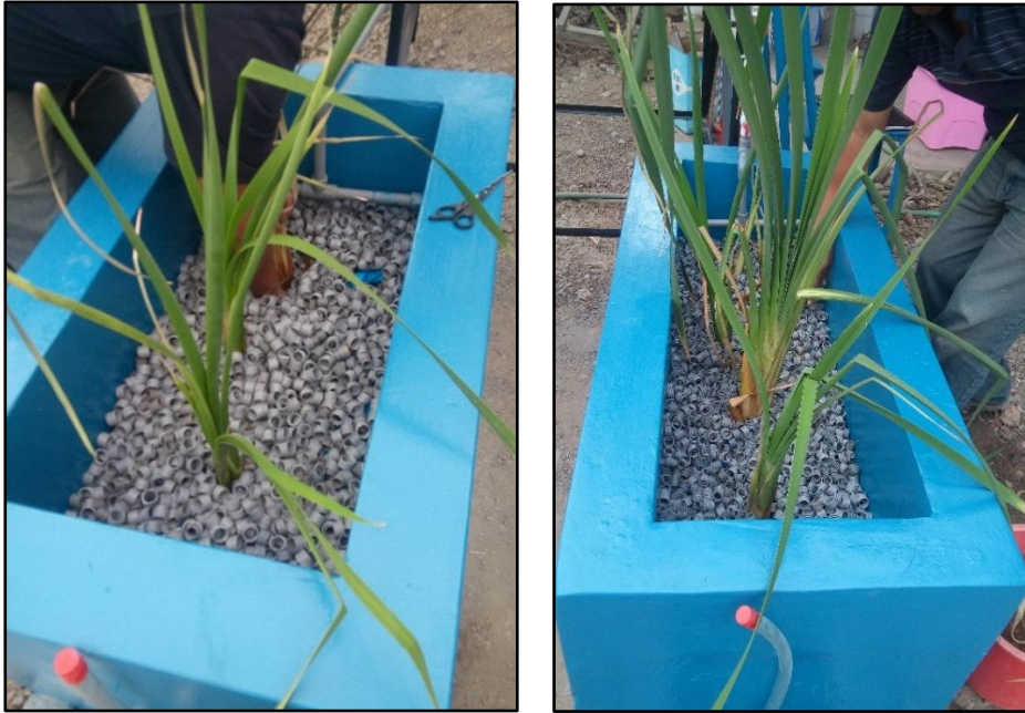
Fotografía N° 1: Sembrado del Scirpus Californicus , a la izquierda el humedal artificial N°1 y a la derecha, el humedal artificial N° 2.
