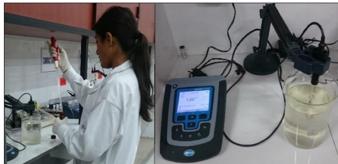
Fotografía N° 24: Acidificación de la muestra con ácido clorhídrico y medición del pH.
