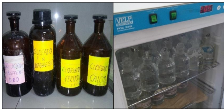
Fotografía N° 16: A la izquierda, nutrientes agregados al agua de dilución. A la derecha, botellas winkler en la incubadora
