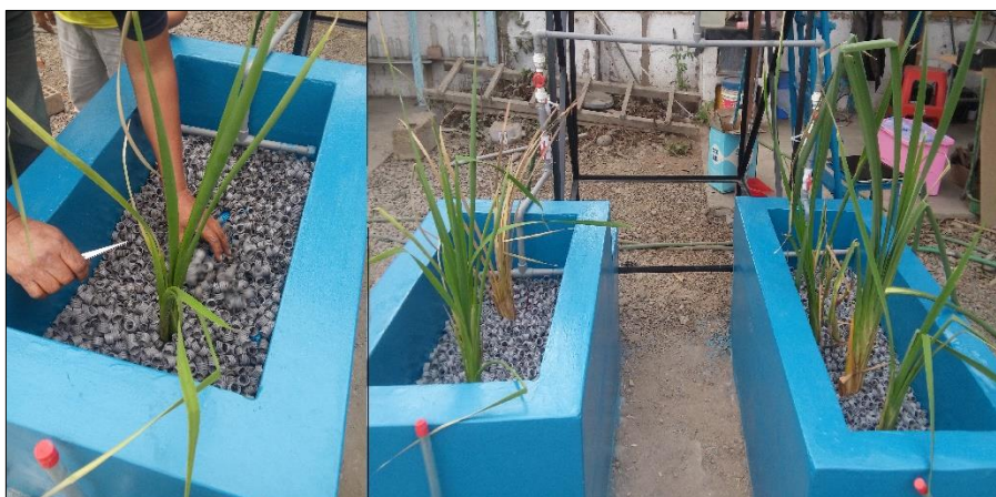
Fotografía N° 10: A la izquierda sembrado de raíces de la macrófita Scirpus californicus , a la derecha imagen posterior al sembrado.
