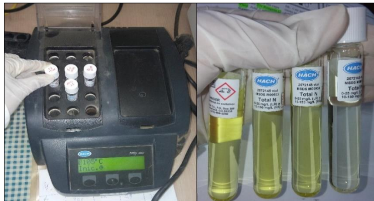
Fotografía N° 21: A la izquierda: Colocación de los viales de Nitrógeno total en el digestor. A la derecha: Viales retirados del digestor a temperatura ambiente.
