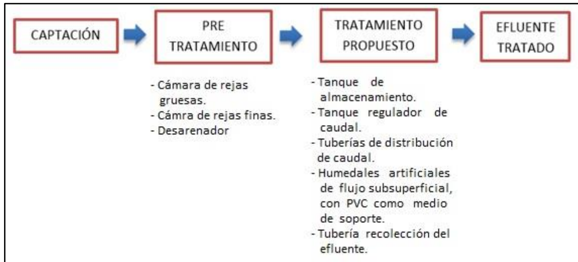
Figura N° 6: Diagrama de flujo del sistema de tratamiento del agua residual
