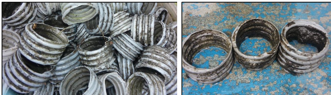
Fotografía N° 3: Formación de biopelícula en el medio de soporte, extraídas en la desinstalación del sistema de tratamiento
