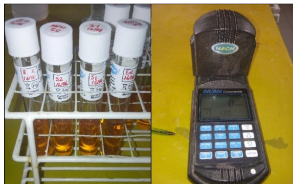
Fotografía N° 18: A la izquierda, viales retirados del digestor; a la derecha, colorímetro DR 850 HACH.
