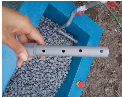
Fotografía N° 7: Tubería distribuidora de caudal
