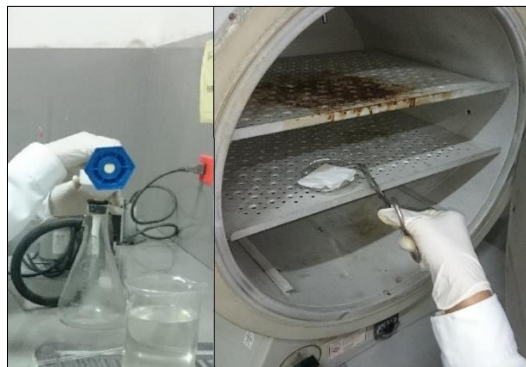
Fotografía N° 25: Filtrado de la muestra al vacío y colocación del papel filtro al horno para su secado.
