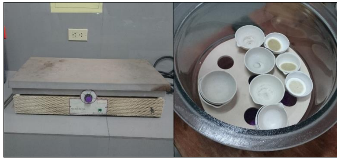
Fotografía N° 19: A la izquierda, plancha de evaporación. A la derecha, desecador y capsulas con muestras.
