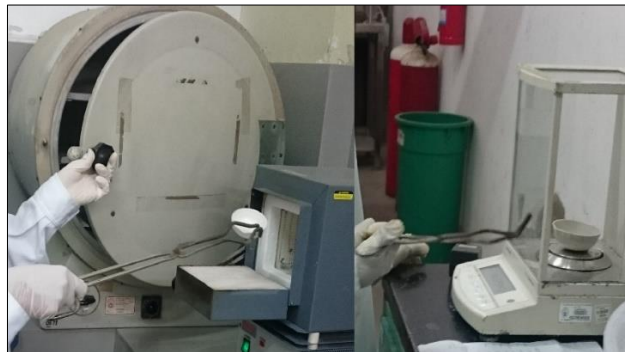
Fotografía N° 20: A la izquierda, colocación de cápsulas a la mufla. A la derecha, pesado de cápsulas en la balanza analítica.
