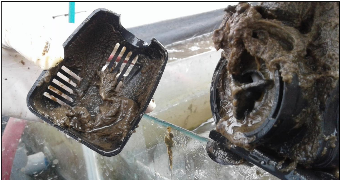
Fotografía 04: Lodo de características visiblemente inorgánico atrapado en el interior del equipo de bombeo. Este problema hacía que el caudal regulado varíe significativamente en sólo dos horas, por ello la limpieza del equipo se debía realizar pasando un día para asegurar que no se encontrara suficiente cantidad de este material en su interior.
