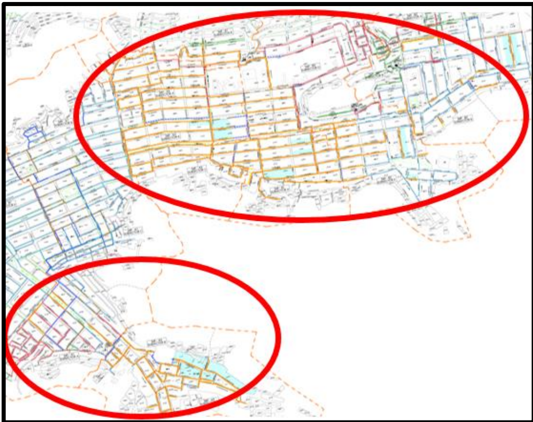
Figura N°12 Presencia de tuberías de agua potable de norma ITINTEC en el proyecto Lima Norte II Lote 1
