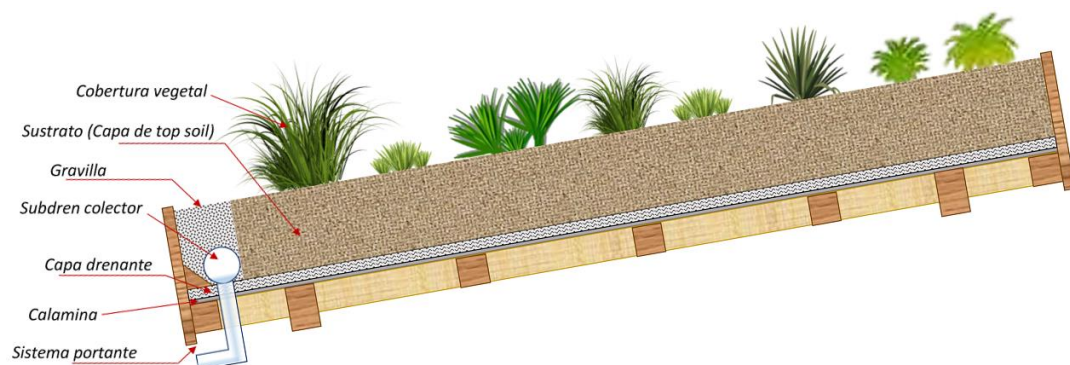
Figura IV.7. Estructura de la cubierta vegetal para los MV.
