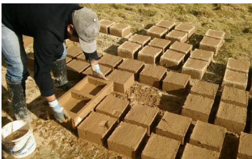
Figura IV.4. Fabricación de las unidades de albañilería de adobe.
