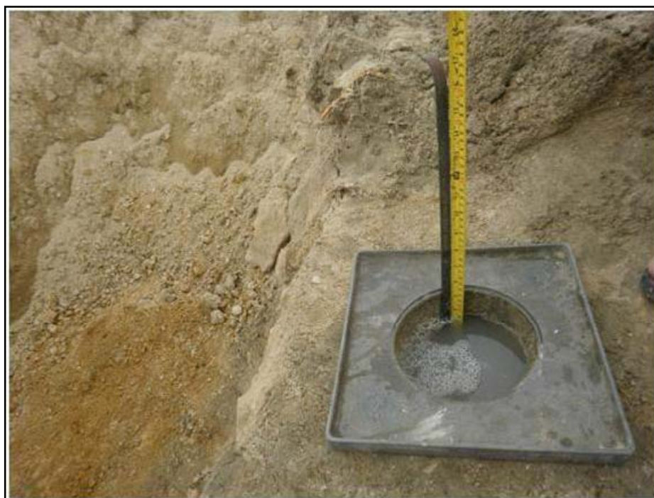
Foto N° 20 : Vista de la ejecución del ensayo de permeabilidad in situ con carga variable, realizado en la calicata C-5.
