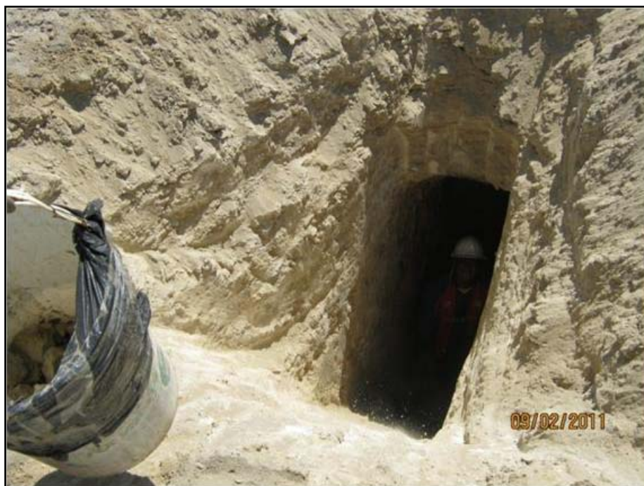
Foto N° 28 :Vista del perfil estratigráfico de la calicata C-7, se observa la obtención de las muestras de suelo representativas.
