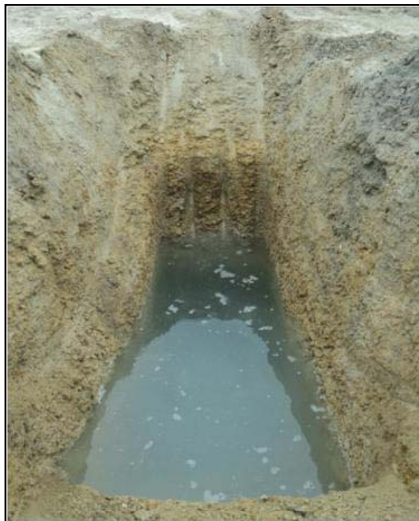
Foto N° 18 : Vista del perfil estratigráfico de la calicata C-5. Se observa el nivel freático encontrado en la calicata a la profundidad de 1.25 m.
