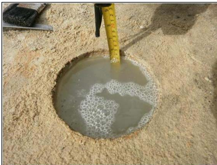
Foto N° 10 : Vista de la ejecución del ensayo de permeabilidad in situ con carga variable, realizado a diferentes profundidades de la calicata C-3.
