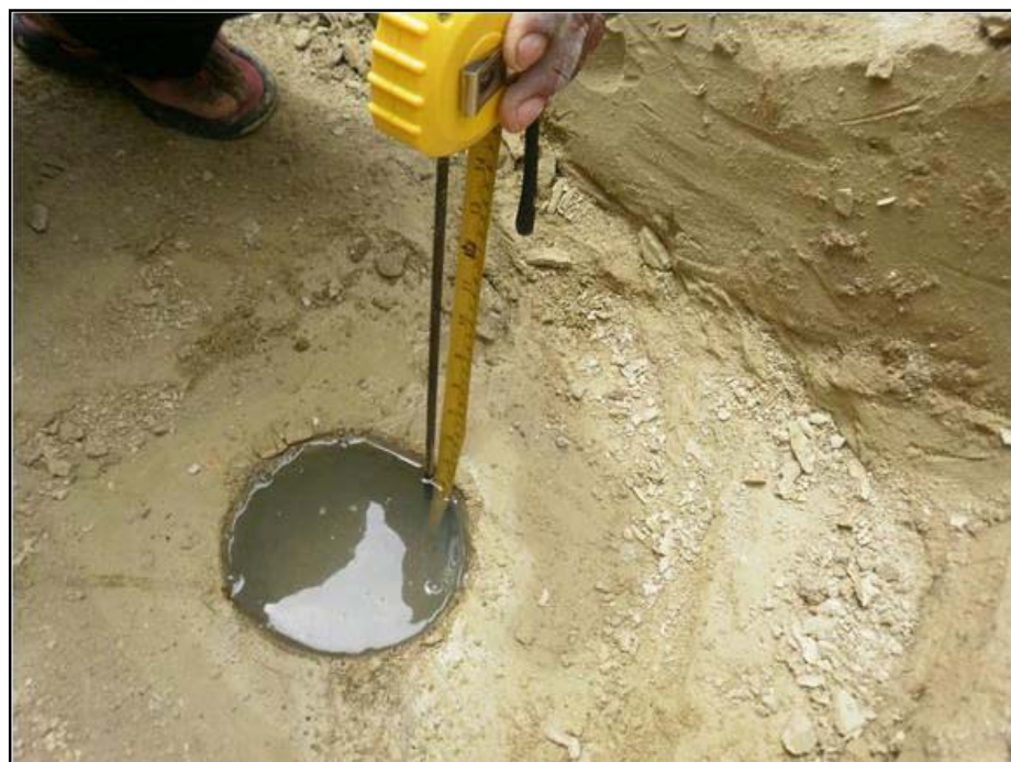
Foto N° 4 : Vista de la ejecución del ensayo de permeabilidad in situ con carga variable realizado a diferentes profundidades en la calicata C-1.
