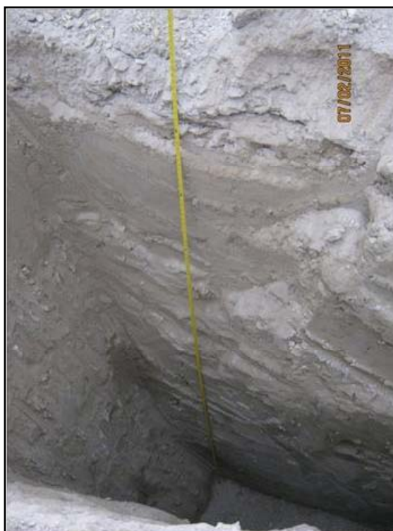
Foto N° 2 : Vista del perfil estratigráfico de la calicata C-1. Se observa los estratos encontrados en el perfil de la calicata y no se observa la presencia del nivel freático hasta la profundidad de exploración.
