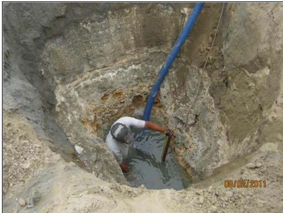
Foto N° 11 : Vista de la ejecución del ensayo de permeabilidad in situ por recuperación de caudal, realizado en la calicata C-3.
