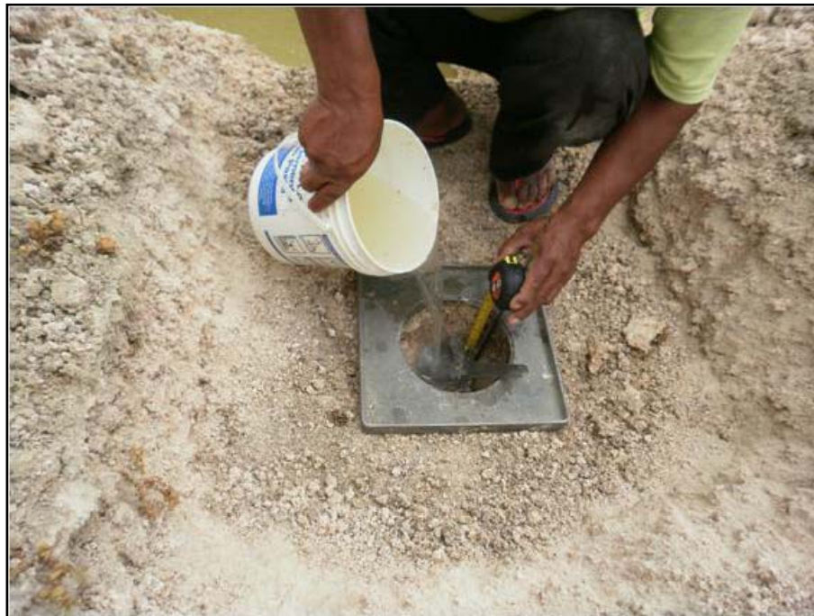
Foto N° 15 : Vista de la ejecución del ensayo de permeabilidad in situ con carga variable realizado en la calicata C-4.
