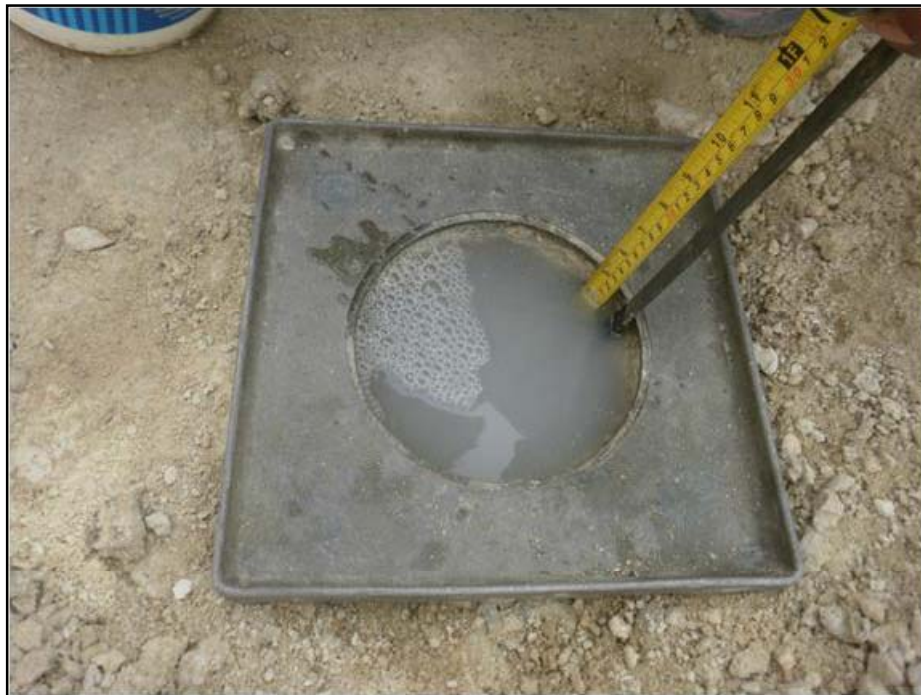
Foto N° 25 :Vista de la ejecución del ensayo de permeabilidad in situ con carga variable, realizado a diferentes profundidades en la calicata C-6.
