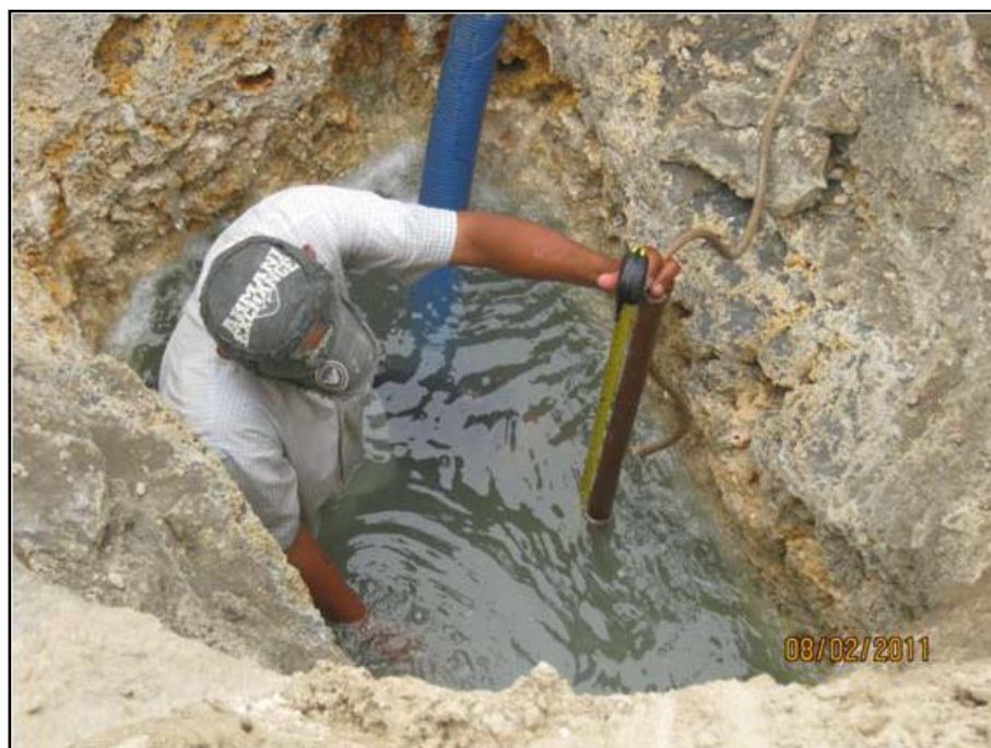
Foto N° 12 : Otra vista de la ejecución del ensayo de permeabilidad in situ por recuperación de caudal, realizado en la calicata C-3.
