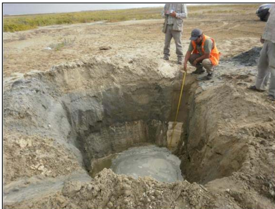
Foto N° 8 : Vista del perfil estratigráfico de la calicata C-3. Se observan los estratos encontrados en el perfil de la calicata y la presencia del nivel freático a los 1.40 m de profundidad.
