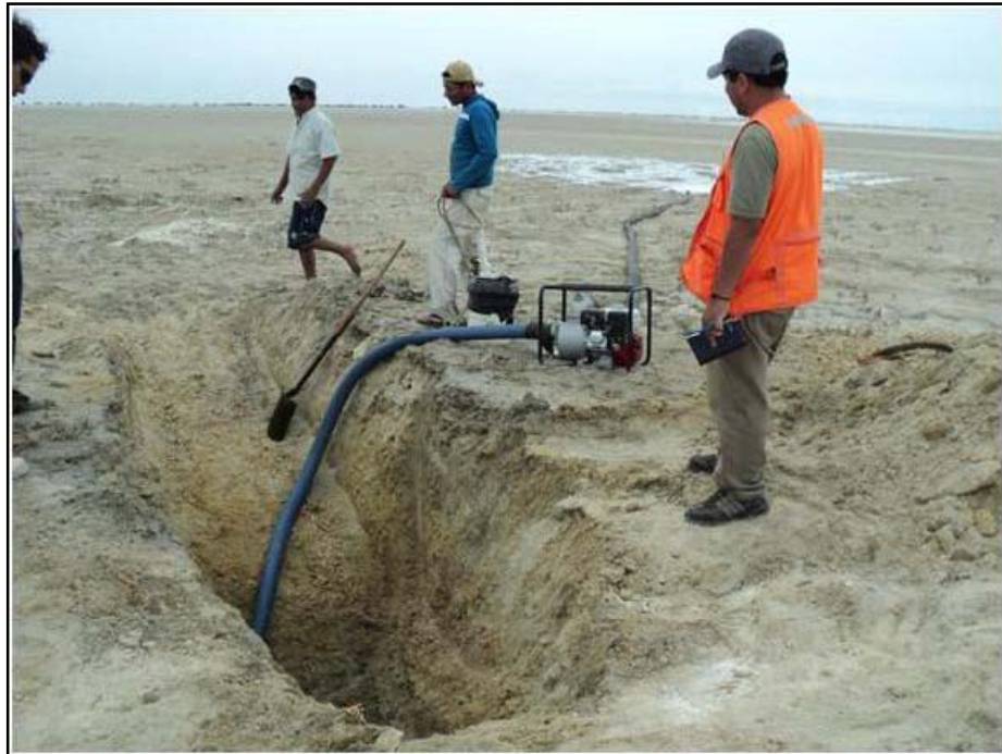
Foto N° 21 :Vista de la ejecución del ensayo de permeabilidad in situ por recuperación de caudal, realizado en la calicata C-5.
