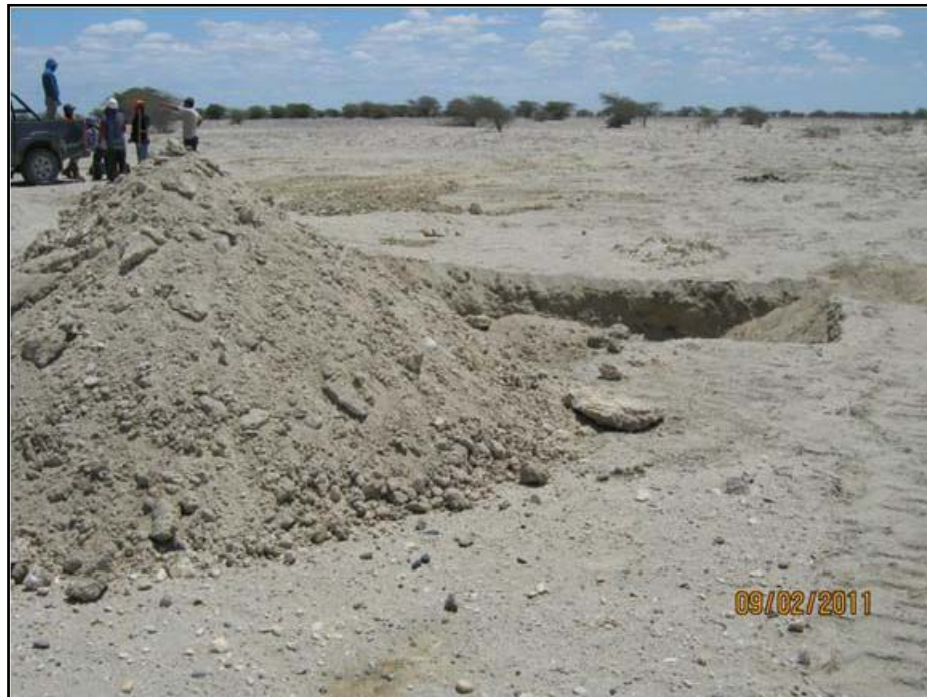
Foto N° 27 :Vista panorámica de la ubicación y ejecución de la calicata C-7, se observa el material extraído durante la excavación. No se encontró presencia del nivel freático hasta la profundidad de exploración.
