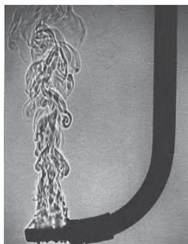
Figura 29. Transferencia de calor por convección.[26]
