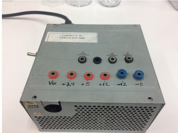
Figura 42. Fuente de poder ATX adaptada para alimentar el circuito electrónico de control del sistema de control de temperatura.
