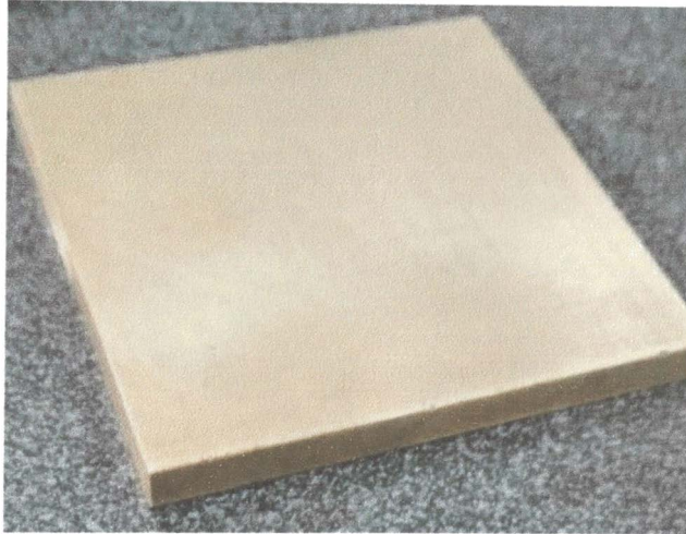
Figura 10. Placa de cobre 60 mm x 60 mm x 5 mm.
