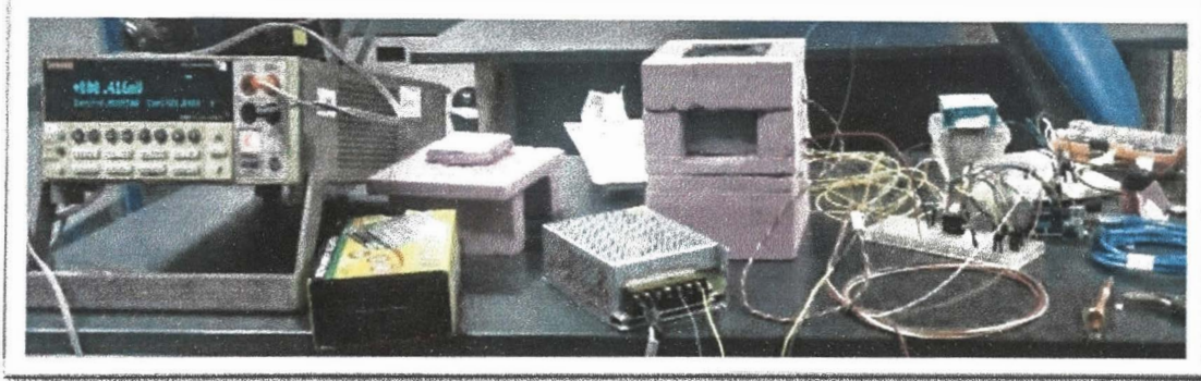
Figura 16. Prueba del control de temperatura de ambas placas y respuesta de los transductores.
