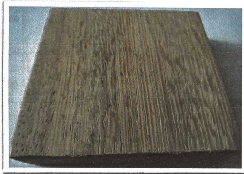
Figura A1.6. Muestra de madera Huayruro de 60 mm x 60 mm x 12,89 mm.
