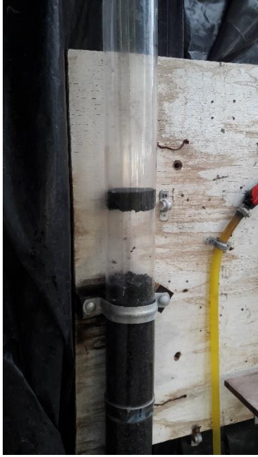
Figura 73: Expansión de filtro de arena
