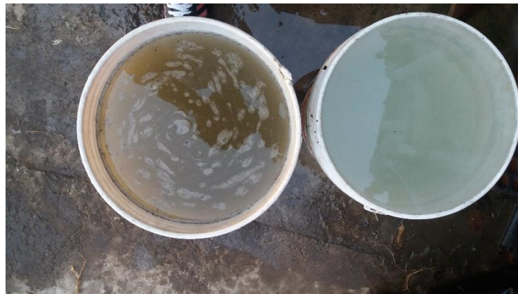
Figura 75: De izquierda a derecha, se verifica evacuación de agua de lavado con 20 litros de agua, y el agua eliminada durante el acondicionamiento de filtros de arena.
