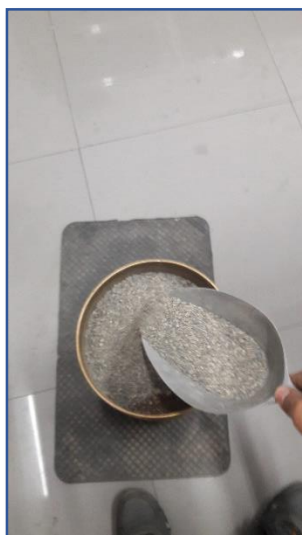
Figura 62: Zarandeo durante un intervalo de veinte minutos
