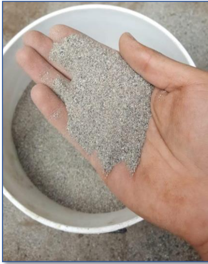
Figura 69: Medio Filtrante de lecho Convencional
