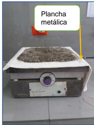
Figura 60: Secado de la Arena
