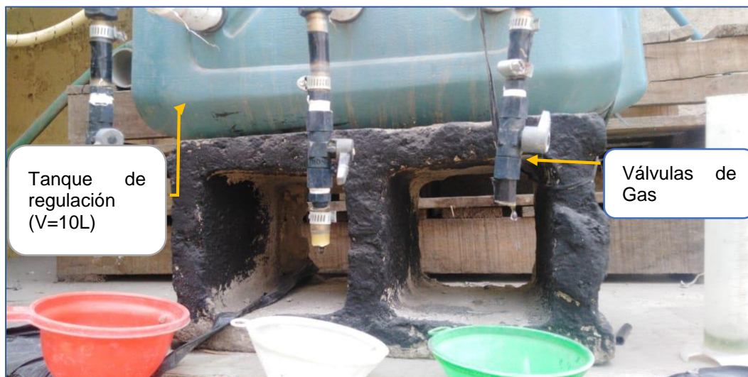
Figura 55: Sistema de regulación.
