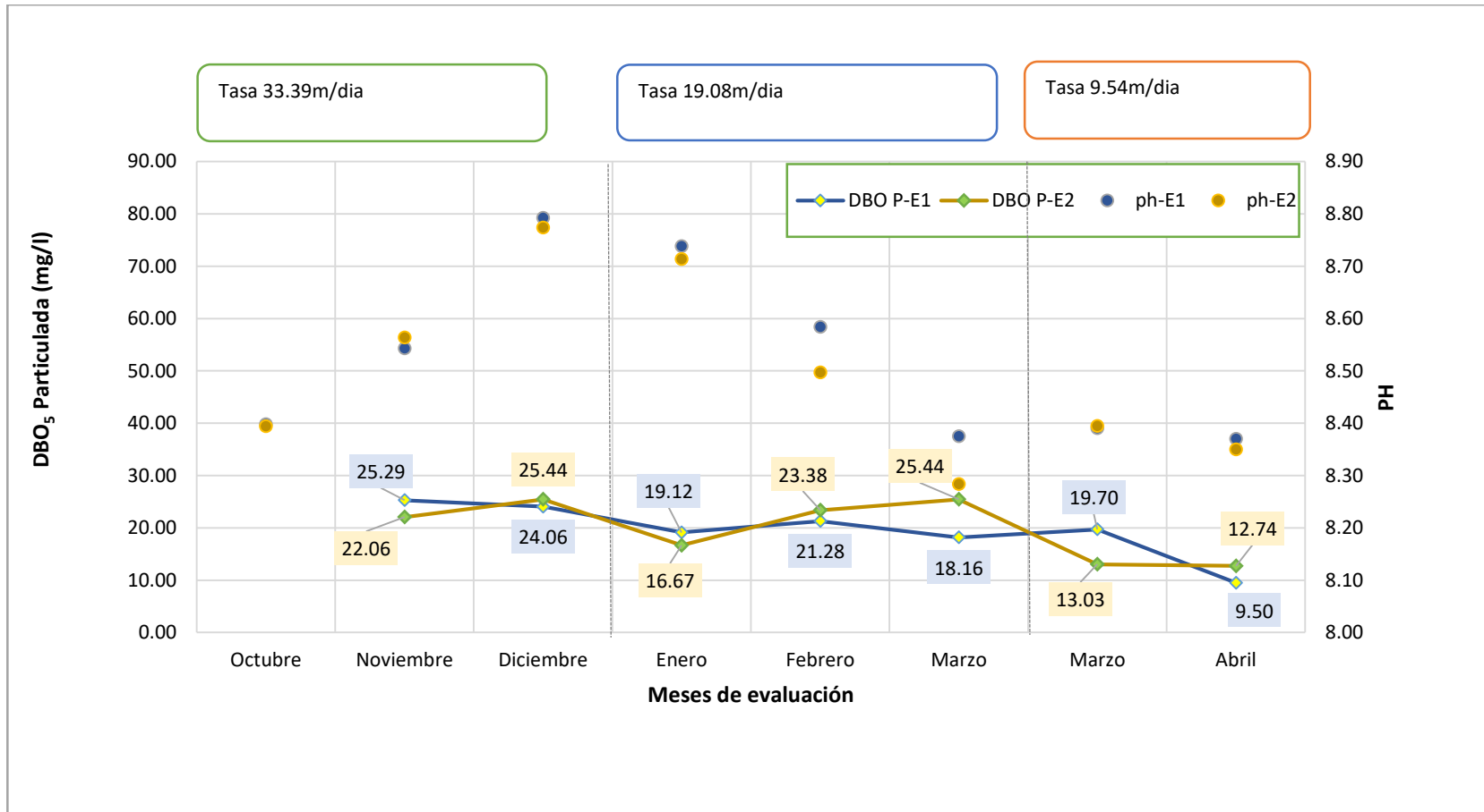
Figura 39: Variación de DBO 5 Particulada en el efluente del segundo filtro, de ambos sistema de filtros de arena evaluados (I y II), relacionados con la variación de PH.
