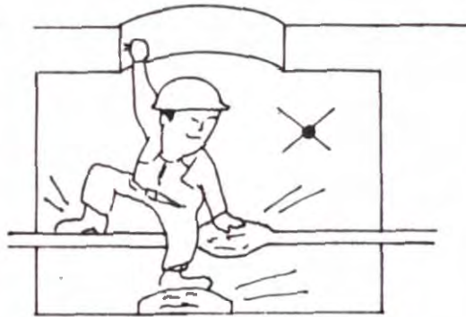
NO BAJAR PISANDO LOS CABLES
