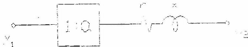
d) Transformador con Taps en P.U.
