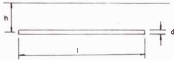
Figura 1-18. Electrodo horizontal enterrado a una profundidad h
