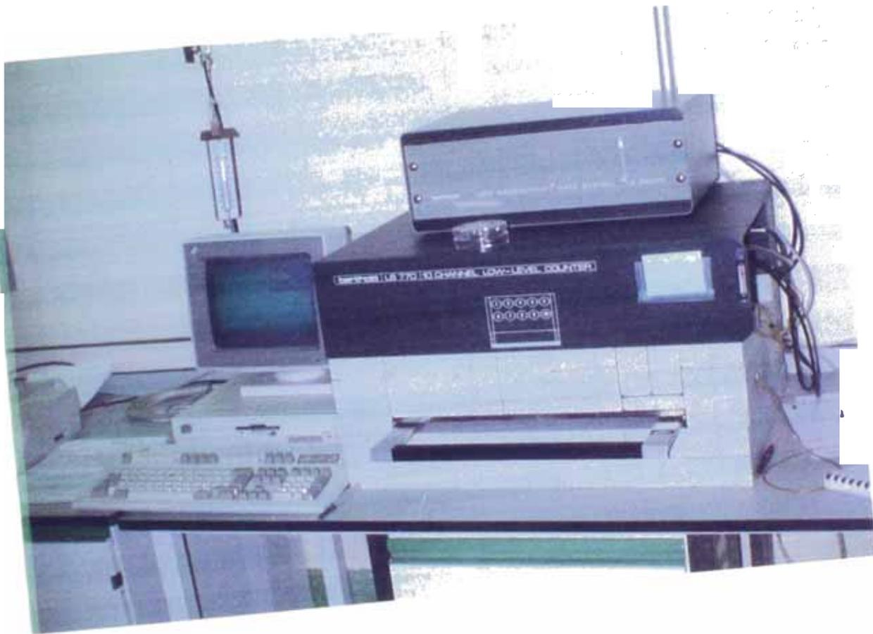
Foto No. 09 "Cadena de Espectrometria Gamma.
