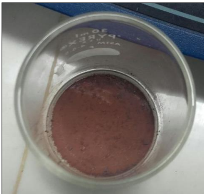
Figura 5. Obtención de un sólido rojo vino que corresponde al aducto acetato de rodio-metimazol.
