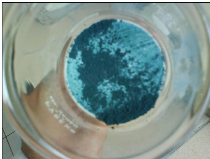
Figura 4. Obtención de un sólido verde claro, que corresponde al Tetrakis(acetato) de Rh_2(II,II) .
