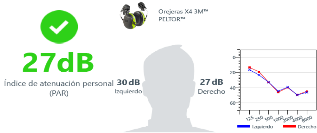
Figura 41. Atenuación de sonido obtenida con uso de la orejera 3M Peltor X4P51E en el fundidor.
