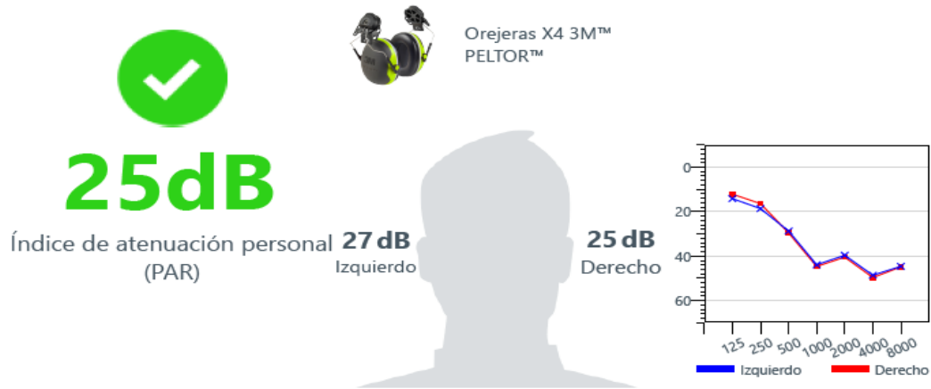
Figura 42. Atenuación de sonido obtenida con uso de la orejera 3M Peltor X4P51E en el ayudante fundidor 1.
