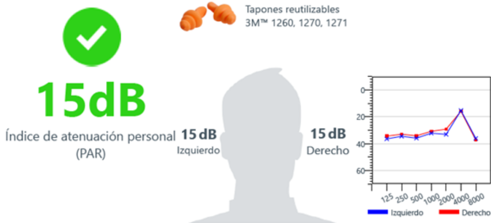
Figura 40. Atenuación de sonido obtenida con uso del tapón auditivo 3M 1271 en el ayudante fundidor 2.
