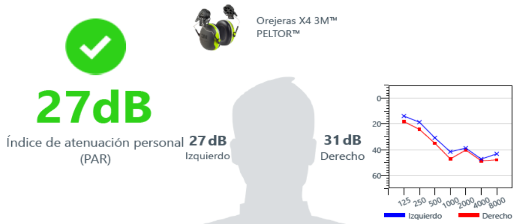
Figura 43. Atenuación de sonido obtenida con uso de la orejera 3M Peltor X4P51E en el ayudante fundidor 2.
