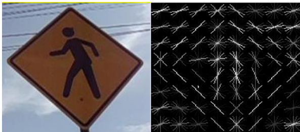
Figura 14 HOG de señal peatonal
