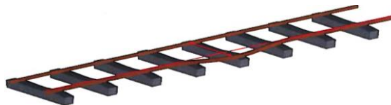
Fig. N° 2.24 Defectos de ancho de vía
