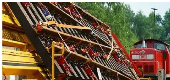
Fig. N° 3.2 Vagones basculantes utilizados para transportar paneles de cambiavías de fábrica Fuente: (MAINLINE Consortium, 2014, p. 16)
