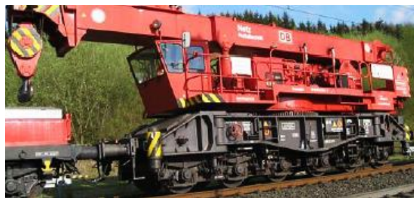
Fig. N° 3.1 Grúa ferroviaria multiusos comúnmente empleada para la renovación del cambiavía Fuente: (MAINLINE Consortium, 2014, p. 15)
