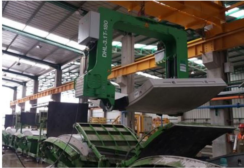
Figura 4.20: Proceso de desencofrado con pinza hidráulica (Fuente: Registro fotográfico de obra)
