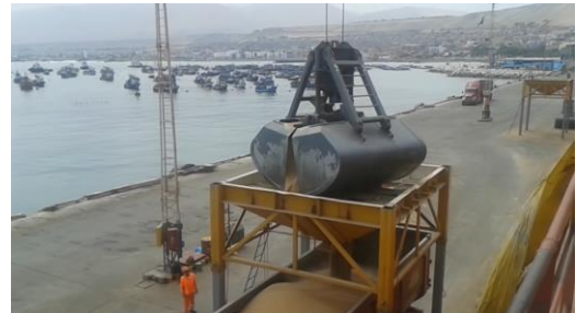
Descarga del grano en la tolva y hacia el camión
