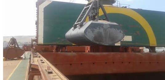
Movimiento de llevada del Clamshell hacia afuera de la nave
