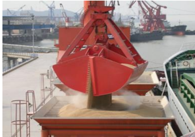
Figura N°5.3 Descarga de granos con grúa y clamshell en el muelle Fuente: Shanghai Qifan Machinery.
