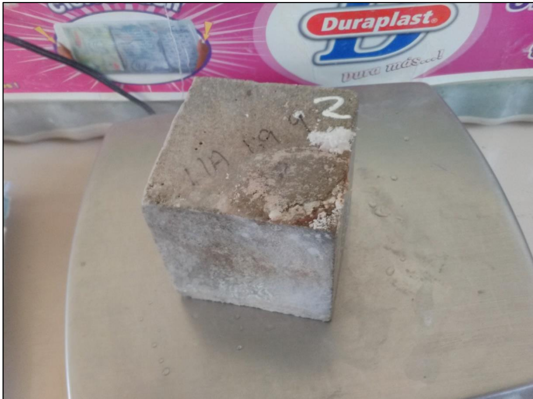
Grafico N°A.09: Muestras después de 15 día del ensayo de capilaridad observándose presencia de salitre en su superficie. Fuente: Elaboración Propia.
