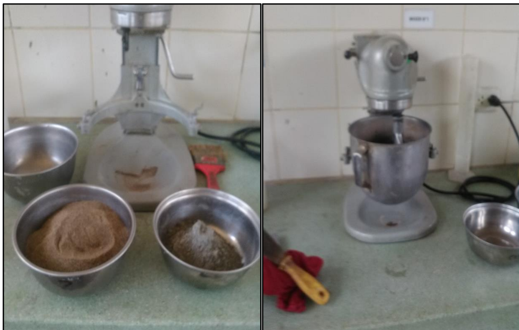
Gráfico N° 6: Preparación de mortero de revestimiento. Fuente: Elaboración propia.
