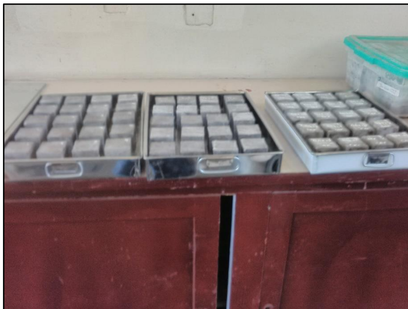
Gráfico N°46: Muestras sumergidas en 3mm de agua-Ensayo Capilaridad. Fuente: Elaboración Propia.
