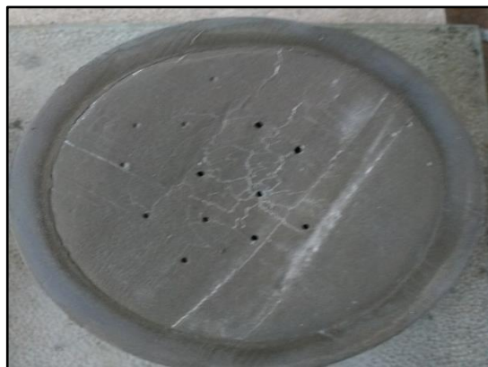
Gráfico N°11: Muestra penetrada en ensayo de tiempo de fraguado. Fuente: Elaboración propia
