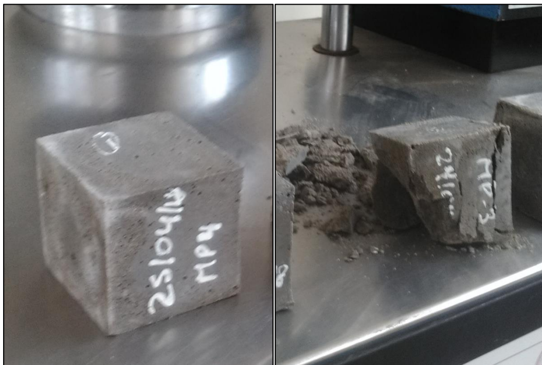
Grafico N°A.03: Máquina para el ensayo de resistencia de compresión Versa Tester, muestra de mortero de revestimiento antes y después del ensayo de resistencia a la compresión. Fuente: Elaboración Propia.
