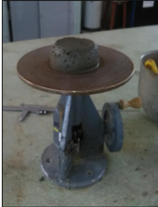
Gráfico N°8: Ensayo de fluidez: mortero desmoldado en mesa de flujo. Fuente: Elaboración Propia.
