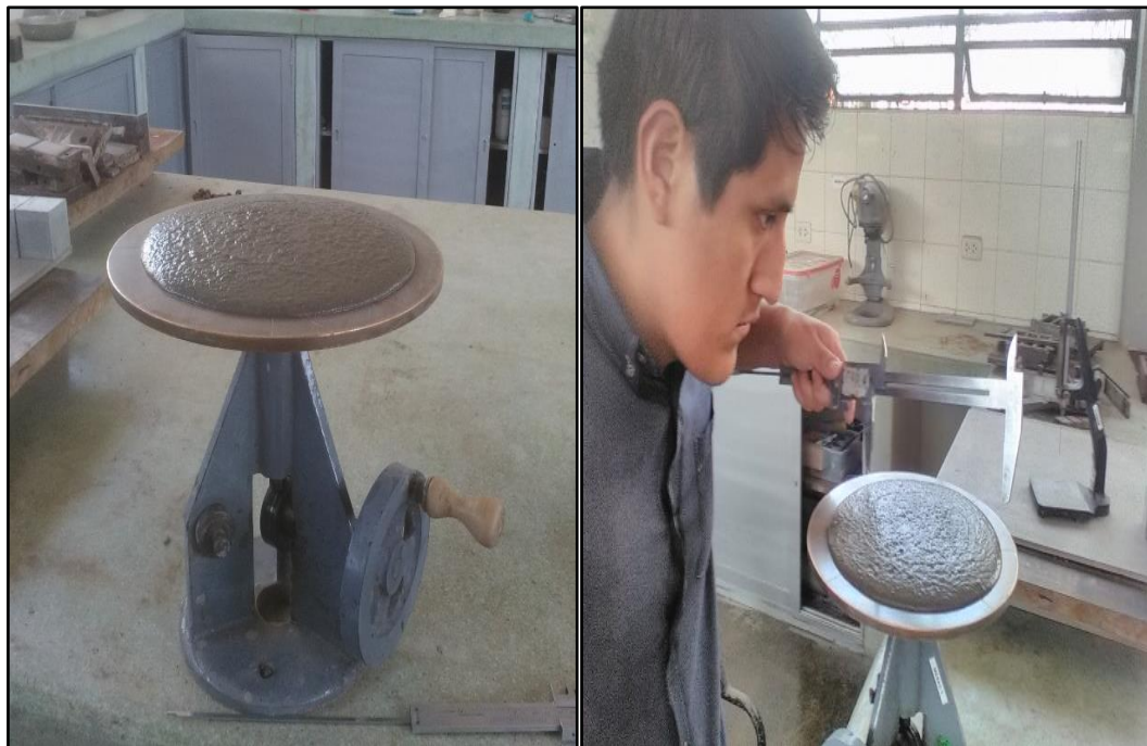
Gráfico N°9: Mortero expandido en mesa de flujo y medición de diámetro. Fuente: Elaboración Propia.
