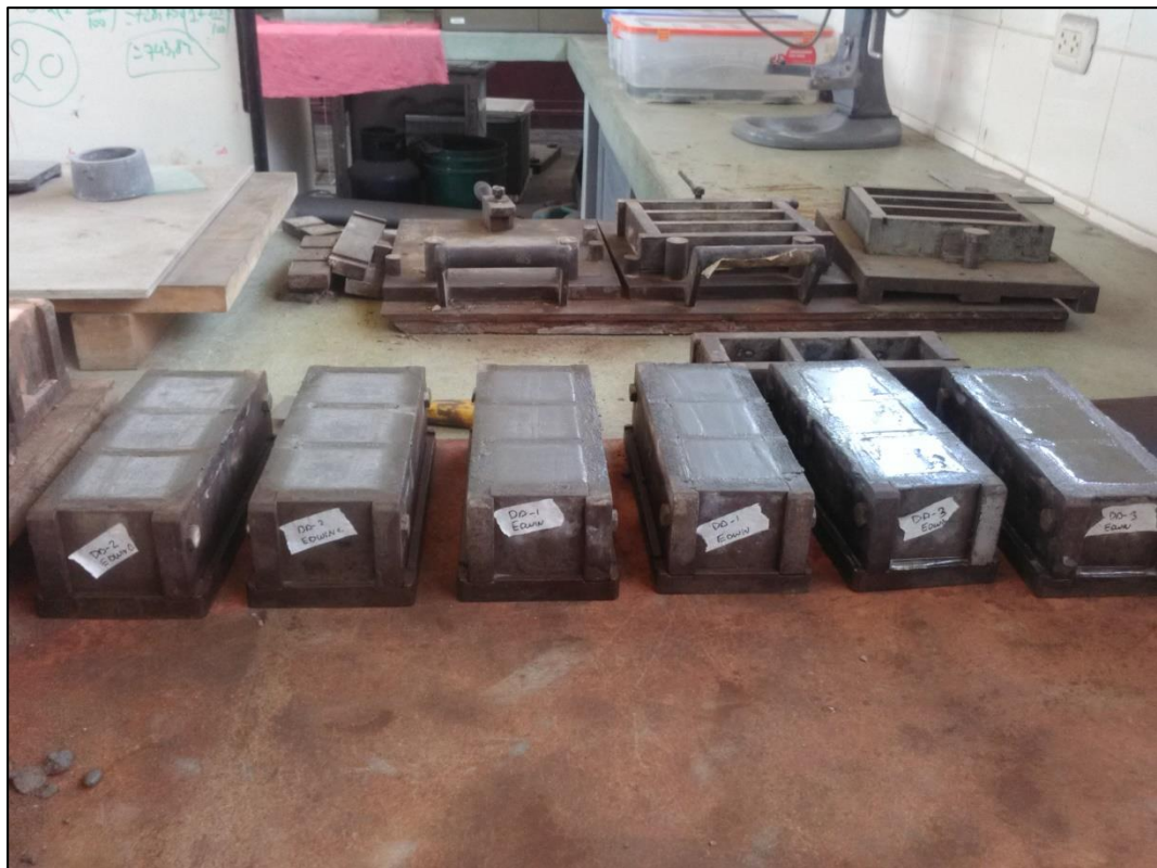
Grafico N°A.05: Moldeado de muestras de mortero de revestimiento para ensayos en su estado endurecido. Elaboración Propia.
