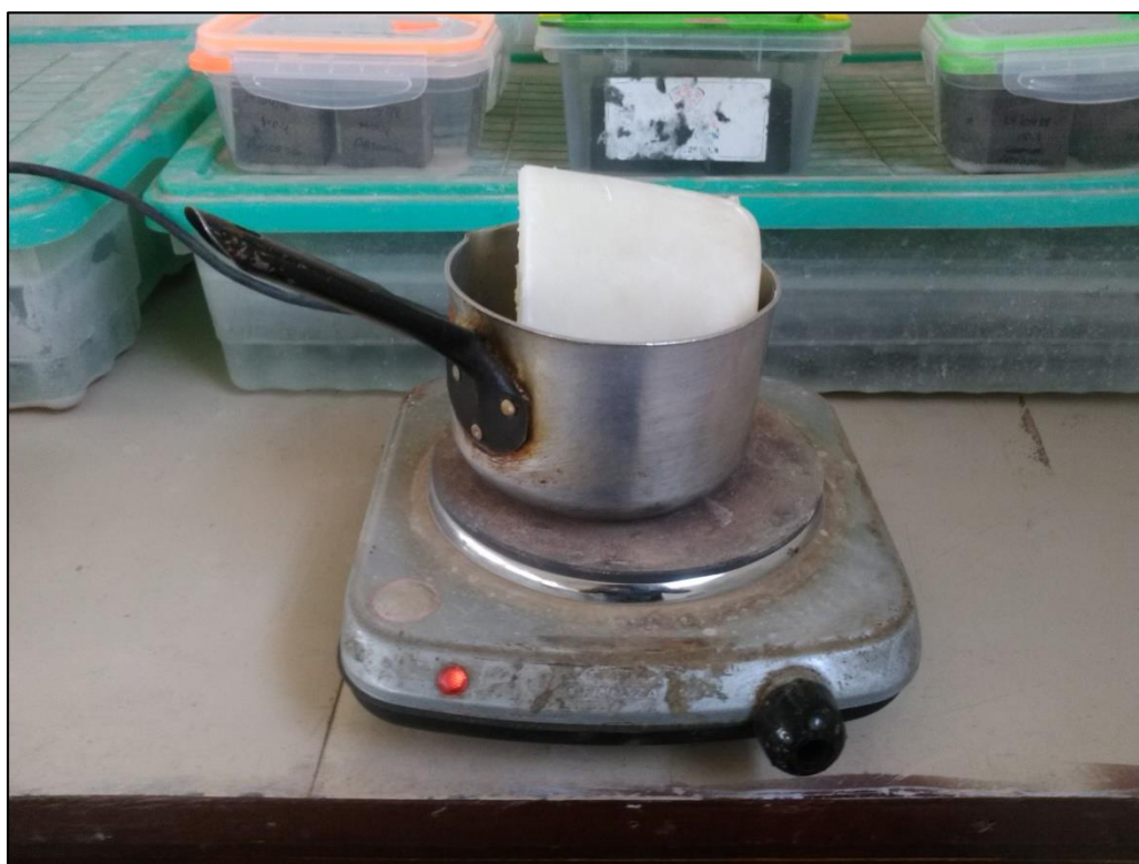
Grafico N°A.07: Preparación de impermeabilizante a base de parafina líquida. Fuente: Elaboración Propia.
