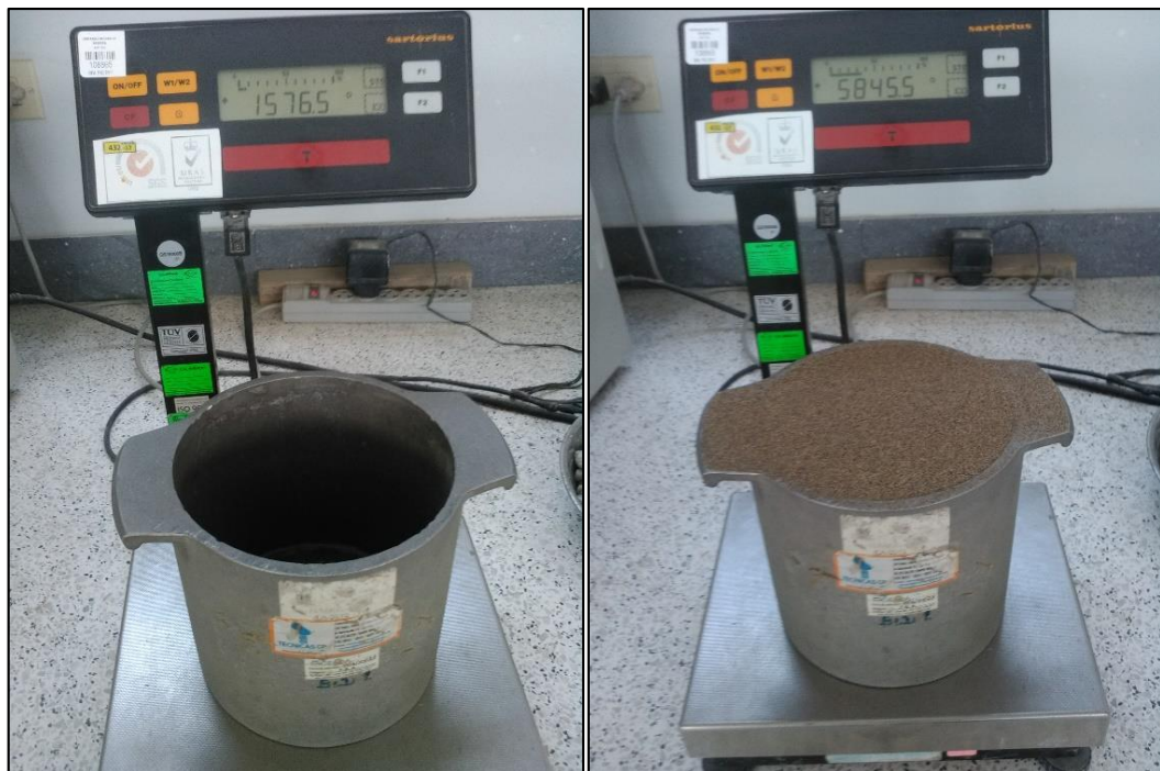
Gráfico N°02: Procedimiento para hallar el P.U.S. de arena fina. Fuente: elaboración propia.
