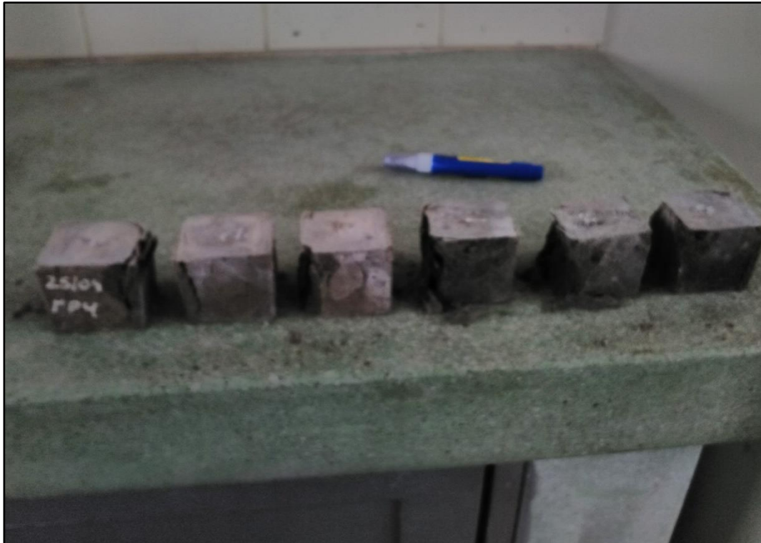
Gráfico N°29: Estado de falla del espécimen – Ensayo de compresión. Fuente: Elaboración Propia.
