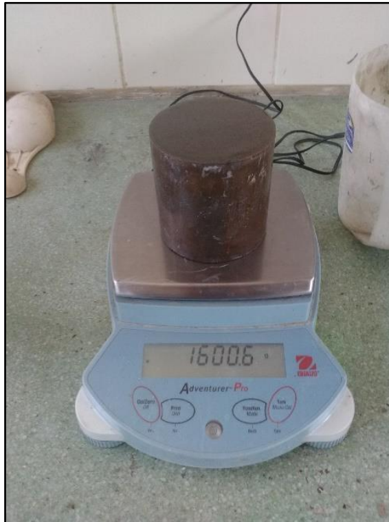
Gráfico N°10: Ensayo de Peso Unitario: Peso de recipiente metálico conteniendo la muestra.
