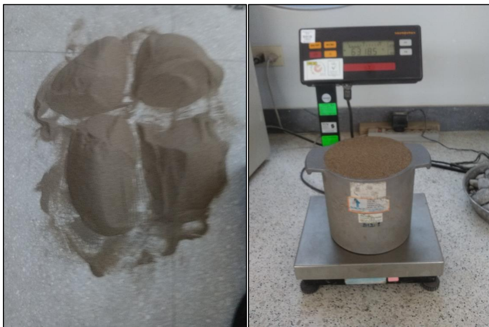
Gráfico N°03: Procedimiento para hallar el PUC del agregado, imagen izquierda: muestreo por el método de cuarteo a la arena fina, imagen derecha: pesado de recipiente con muestra de arena fina. Fuente: Elaboración Propia.
