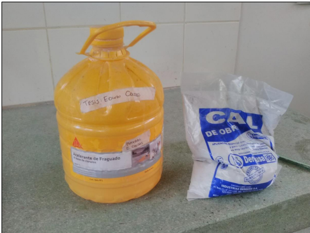
Grafico N°A.02: Preparación de mortero de revestimiento, medición de cantidad de material para cada diseño y aditivo acelerador de fragua SIKA-3 y cal para el curado de muestras. Fuente: Elaboración Propia.
