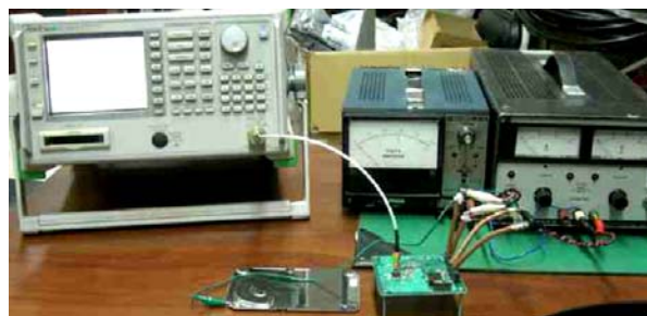
Figura 6.4: Prueba de medición de potencia RF y consumo de potencia
