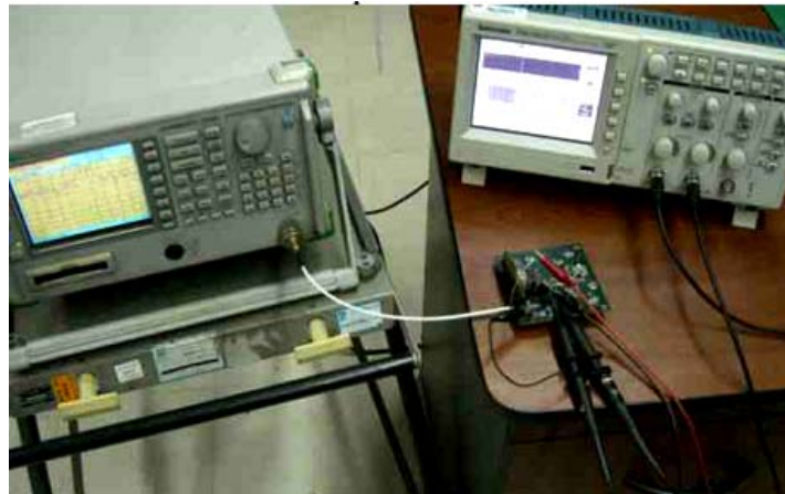
Figura 6.7: Verificación de las señales RF generadas
