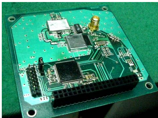
Figura 5.41: Tarjeta PCB con los dispositivos soldados
