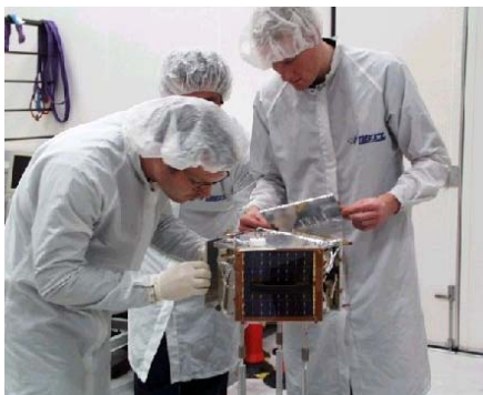
(a) Ensamble de un microsatélite
