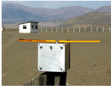
Figura 6.2: Prototipo de estructura y antena radiante en la prueba
