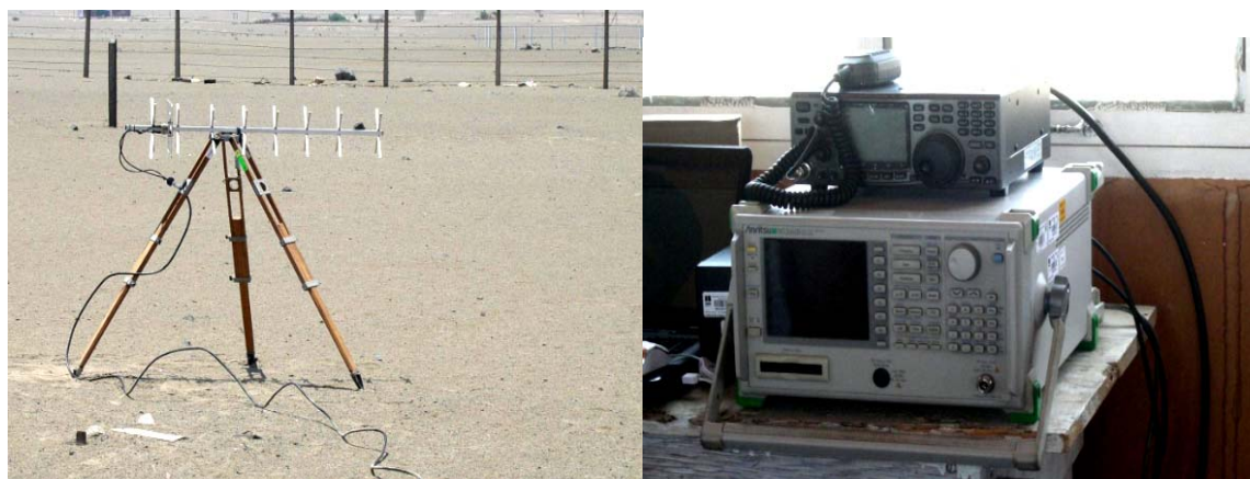
Figura 6.1: Antena y equipamiento utilizado en medición de patrón
