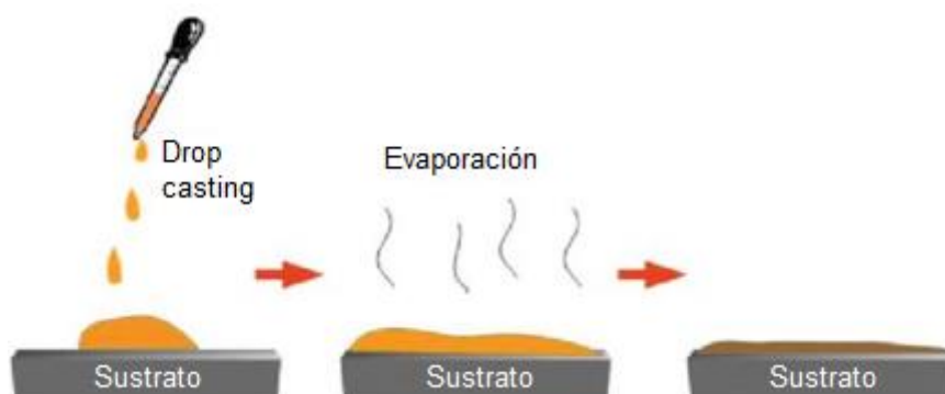
Figura 19. Depósito de perovskita usando la técnica de drop casting [72].
