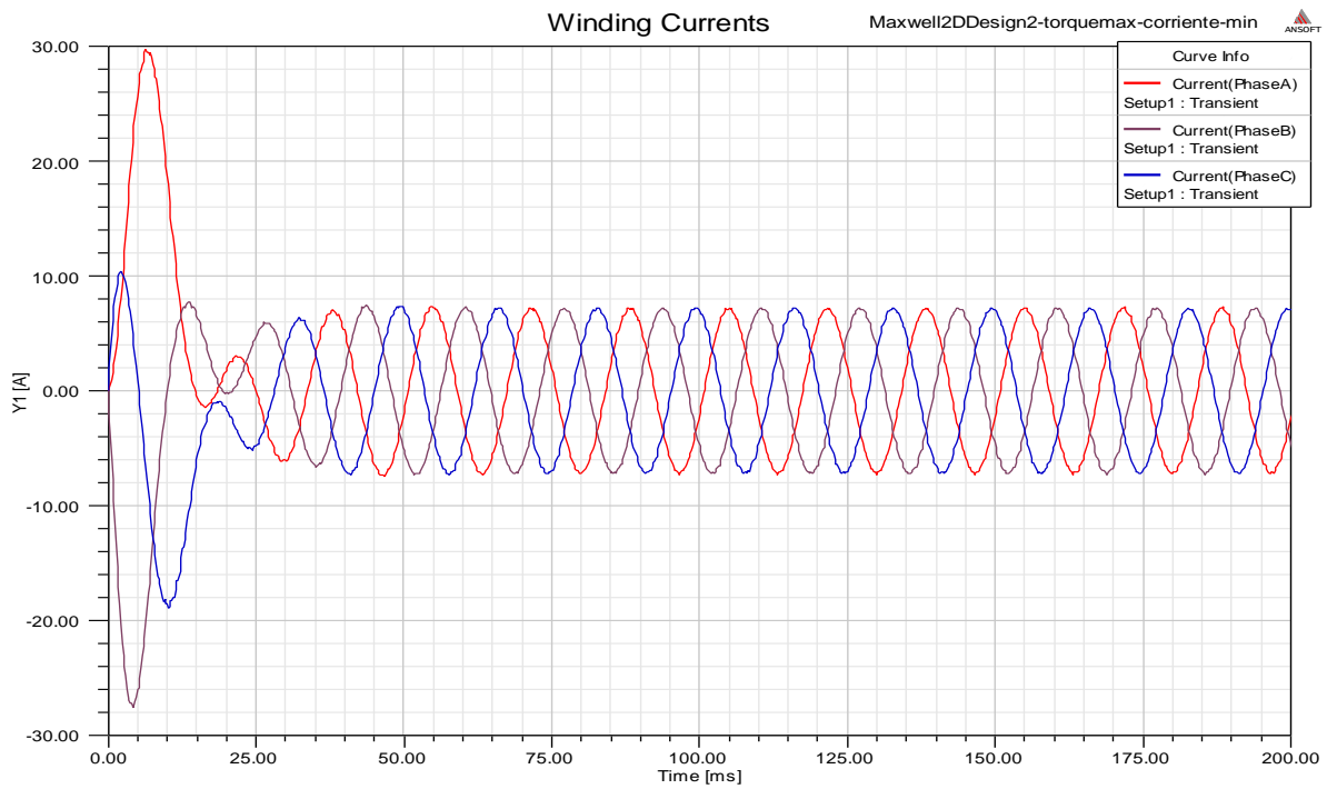
Figura 4.28 Corriente de estator transitoria del motor ranura tipo M1.
