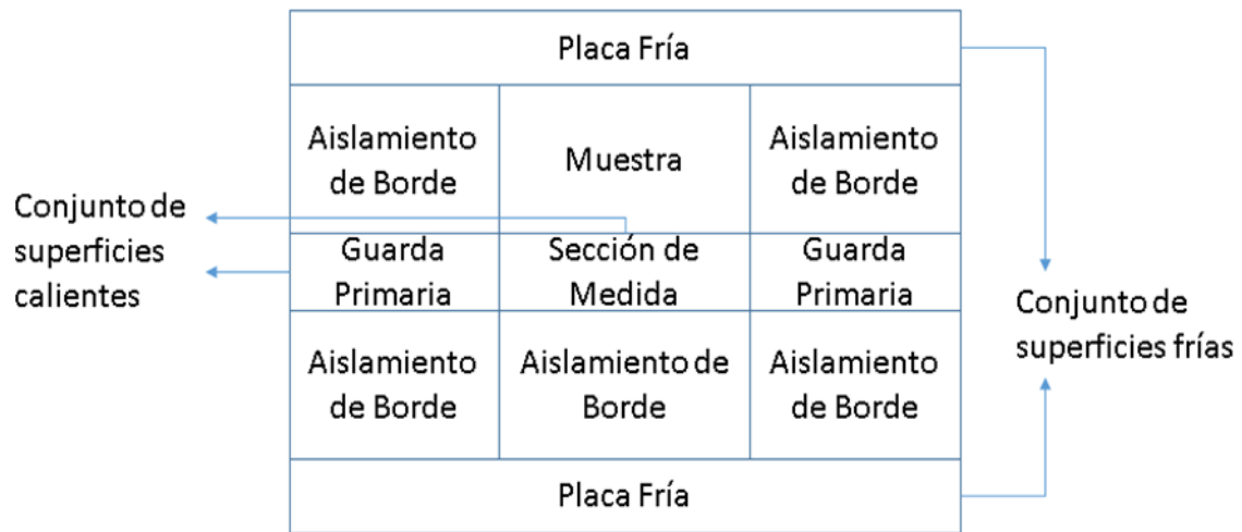
Figura 12. Esquema de configuración de un aparato de placa caliente de doble muestra.
