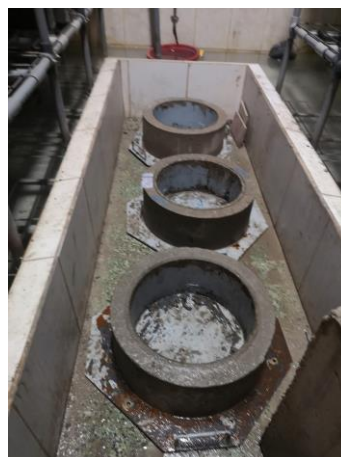
Figura 10 Anillos de concreto en la cámara de curado del LEM UNI Fuente: Elaboración Propia
