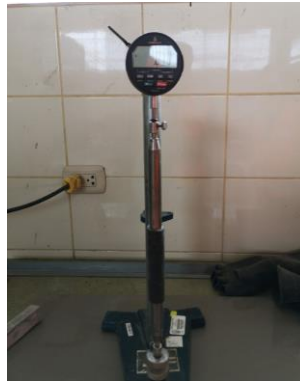
Figura 5 Aparato de medición de cambio de longitud Fuente: Elaboración propia
