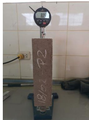
Figura 7 Lectura de longitud de viga Fuente: Elaboración Propia
