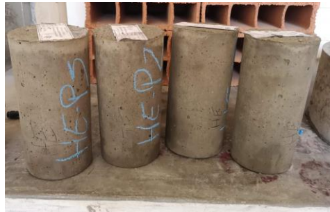
Figura 13 Probetas cilíndricas del diseño con cemento HE. Fuente: Elaboración propia
