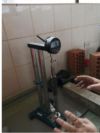
Figura 6 Barra de referencia en el equipo medidor de longitud Fuente: Elaboración propia
