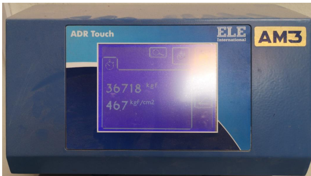
Figura 15 Pantalla digital de la máquina de ensayos a compresión LEM-UNI Fuente: Elaboración propia
