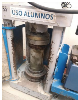
Figura 14 Equipo de ensayo a compresión de probetas cilíndricas Fuente: Elaboración Propia
