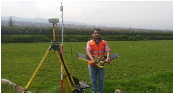
Figura N° 38: Drone eeBe RTK junto con la estación base
