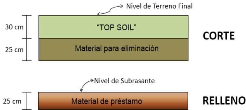
Figura Nº 18: Sección de volumen de corte y de relleno
