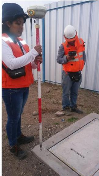
Figura N° 22: Inicio de la monumentación de puntos de control con la ayuda del GPS Trimble R8
