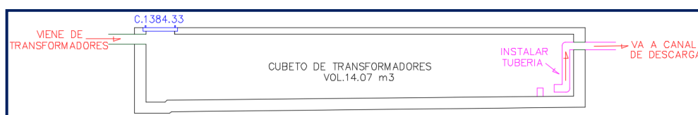
Fig. 4.4. Tubería de descarga - C. H. Huampaní.
