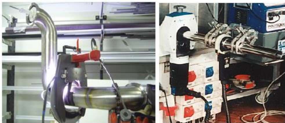
Figura 24. Los cabezales cerrados (derecha) permiten una protección óptima del gas y se emplean para espesores delgados donde no es necesaria la aportación de hilo. Los cabezales abiertos (izquierda), permiten la adaptación de la mayoría de las aplicaciones de TIG orbital, para trabajo en montaje o en taller y con o sin varilla de aporte.
