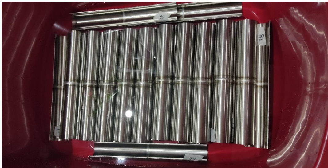
Figura 44. Pasivación con ácido cítrico al 5.74% %v/v.
