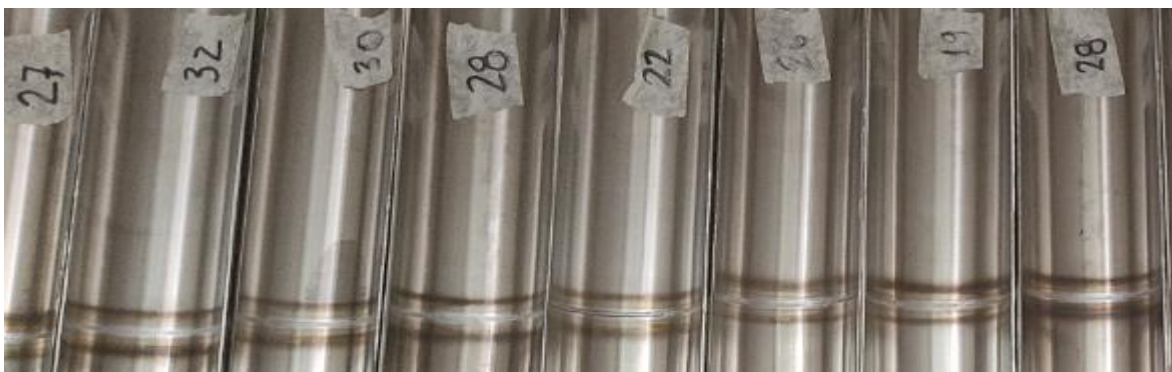
Figura 52. Decoloración de ZAC después del pasivado ( Heat tint ).
