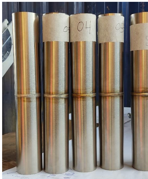
Figura 37. Registro de parámetros de soldadura, resultados conformes 3, 4, 5 y 6. Fuente: Elaboración propia.
