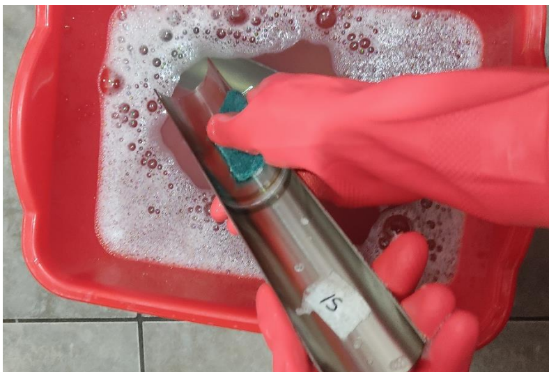
Figura 43. Limpieza manual con detergente alcalino.
