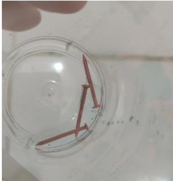
Figura 46. Comprobación de depósito de cobre con elementos de acero.
