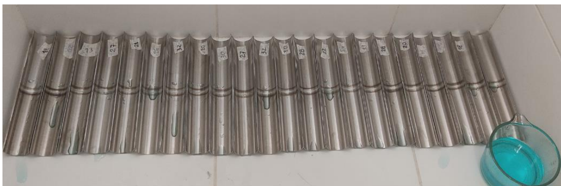
Figura 45. Test de sulfato de cobre en cupones.
