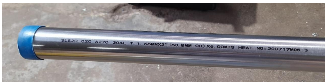
Figura 31. Materiales empleados ASTM A270 304L 50.6 mm OD
