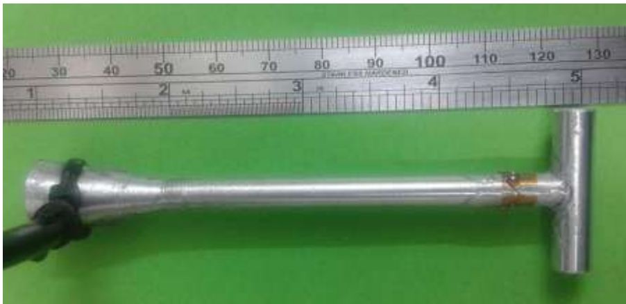
Figura 3.9 T-bar instrumentado en la barra (Trejo, 2015).
