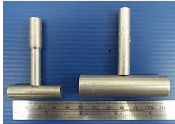
Figura 3.2 Ductos de diámetro de 9 mm y 15 mm (Trejo, 2015).
