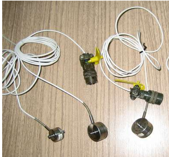
Figura 3.13 Celdas de carga miniatura utilizadas para ensayos centrífugos.
