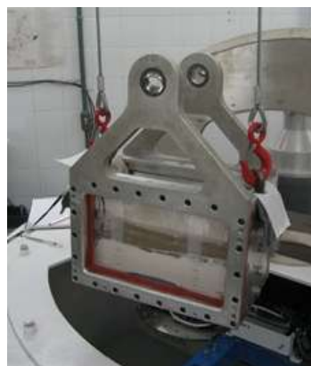
Figura 3.8 Caja de la centrífuga en etapa de colocación dentro de la centrífuga (Almeida et al., 2013).
