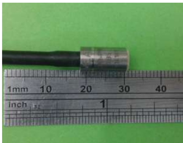
Figura 3.10 Detalle de transductor de poro presión (Trejo, 2015).
