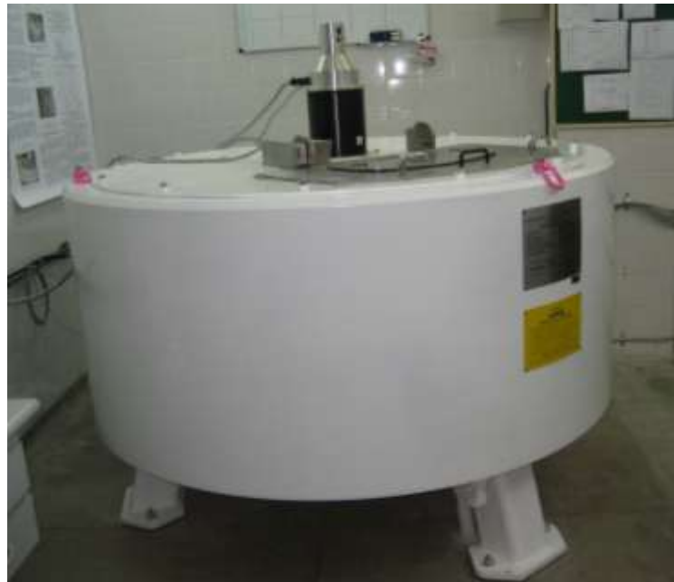
Figura 3.3 Centrifuga de brazo del laboratorio de geotecnia COPPE/UFRJ.
