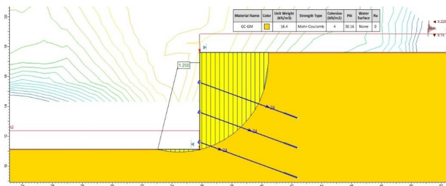
Fig. 5.49. Análisis local del anclaje activo en Muro 1 ( \beta = 20^\circ ; S = 2.00 m)
