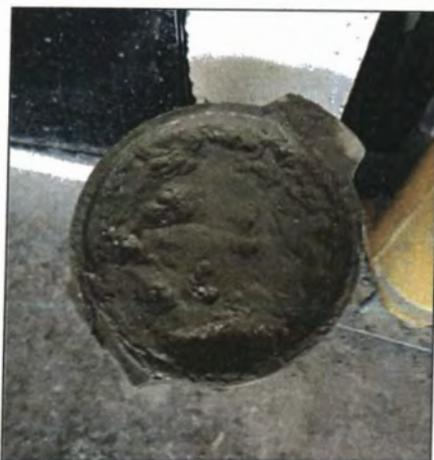
Figura A. 28. Muestra para la medición de la exudación.
