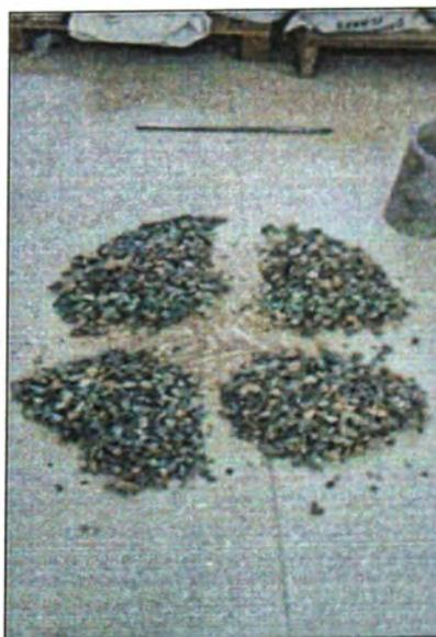
Figura A. 10. Cuarteo del agregado grueso para realizar el ensayo de Peso Unitario.
