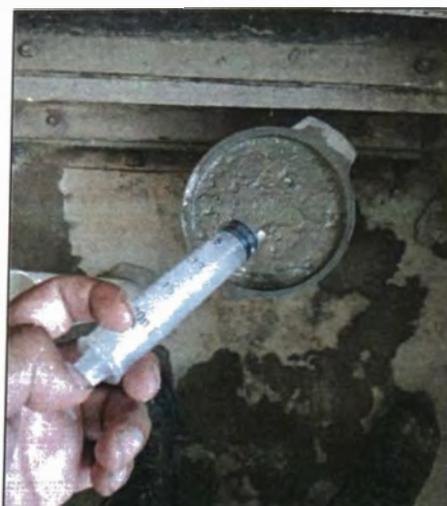
Figura A. 29. Ensayo exudación.
