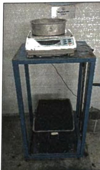
Figura A. 5. Balanza hidrostática para el cálculo del peso de la muestra saturada en agua.
