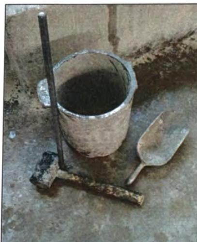
Figura A. 27. Equipo para la medición de la exudación.
