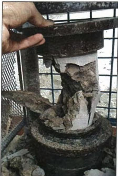
Figura A. 38. Modo de rotura de un testigo.
