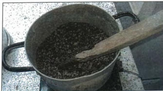
Figura A. 7. Calentamiento de la muestra del agregado fino para determinar su Peso Específico.
