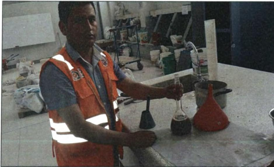
Figura N° III.8. Determinación peso específico del agregado fino.
