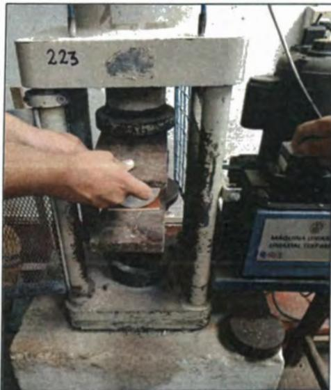
Figura A. 40. Colocación del testigo.
