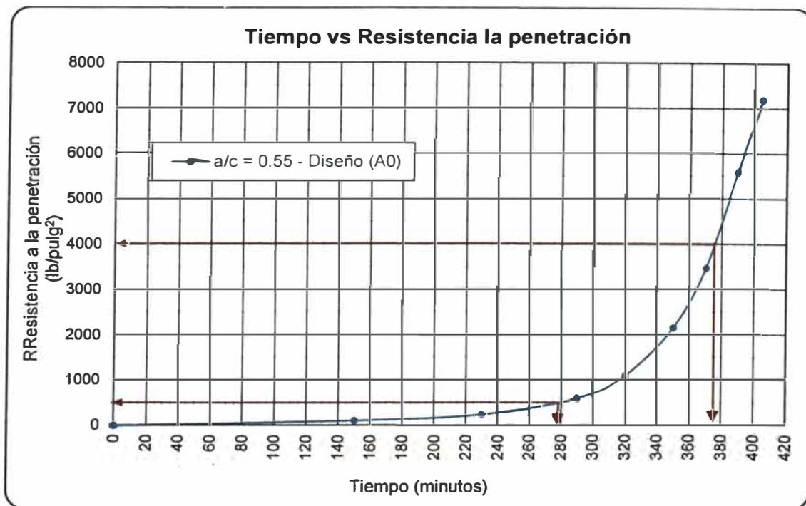
Figura N° VI.10. Tiempo vs Resistencia a la penetración, diseño (A0).
