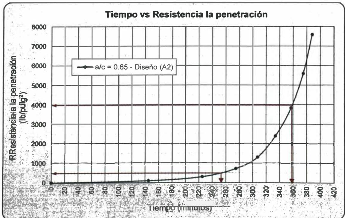
Figura N° VI.16. Tiempo vs Resistencia a la penetración, diseño (A2).
