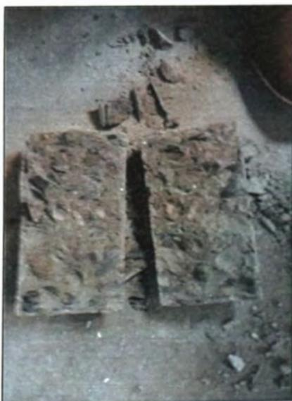
Figura A. 42. Rotura de un testigo en el ensayo por compresión diametral.
