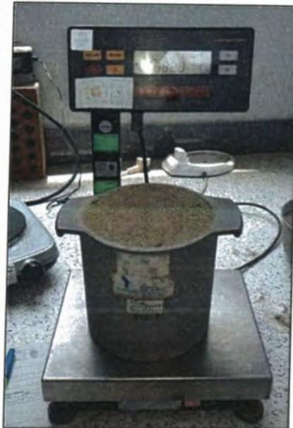
Figura A. 13. Ensayo de Peso Unitario del agregado fino.
