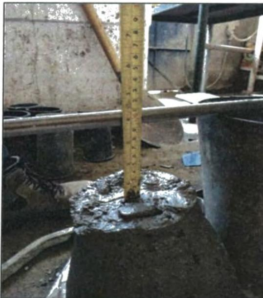
Figura N° V.1. Ensayo de Asentamiento (slump).
