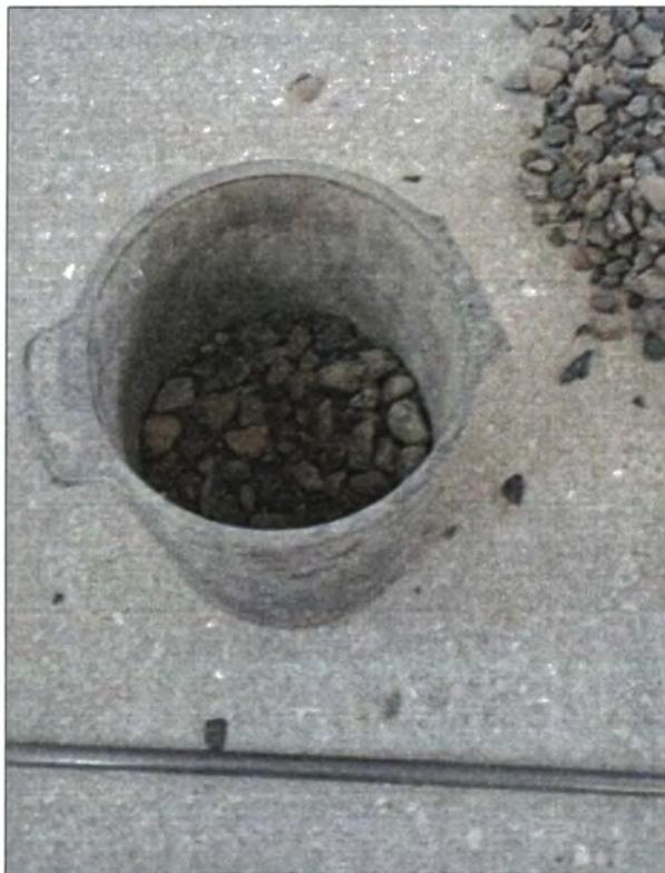
Figura N° III.11. Muestra Peso Unitario del agregado grueso.
