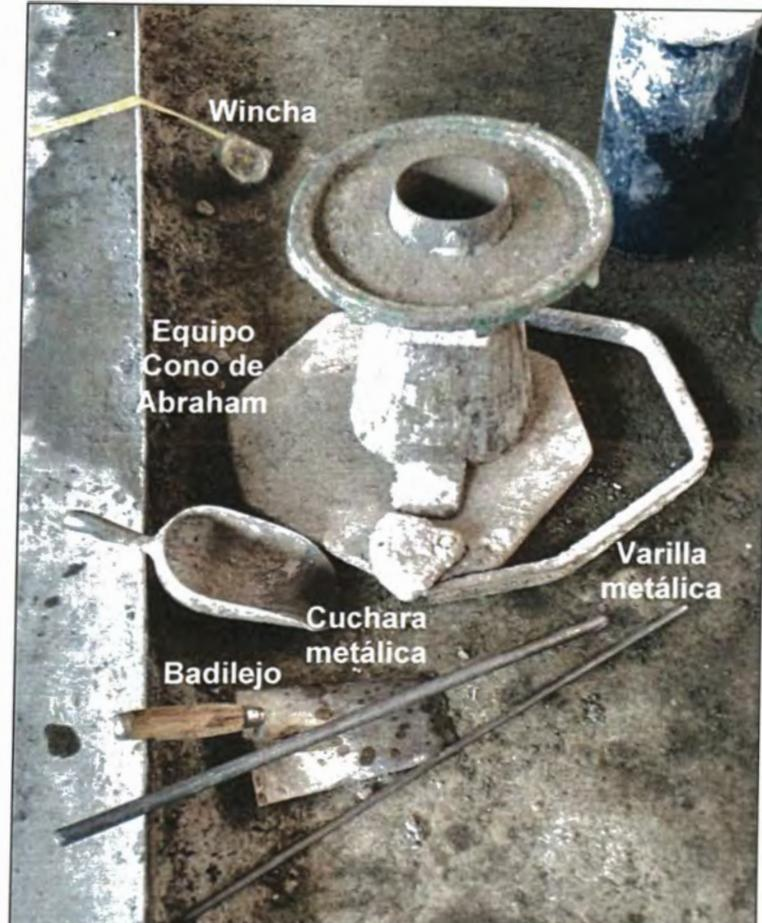
Figura A. 14. Equipo de Cono de Abraham y herramientas adicionales.
