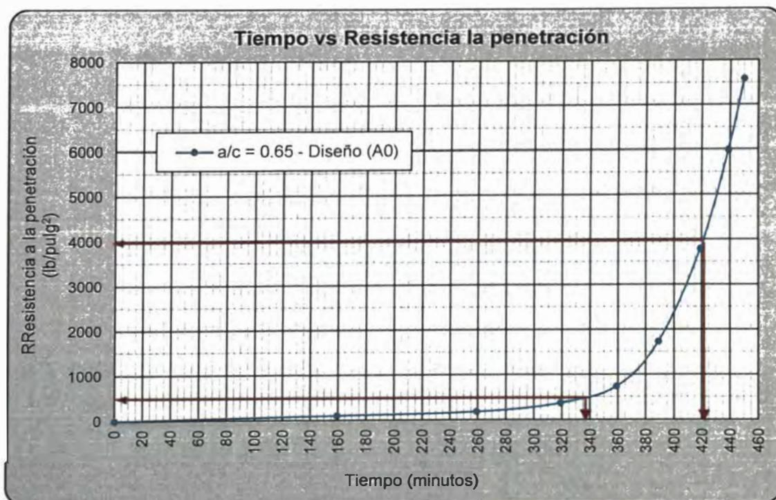
Figura N° VI.14. Tiempo vs Resistencia a la penetración, diseño (A0).
