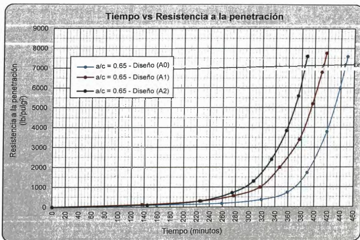
Figura N° VI.17. Tiempo vs Resistencia a la penetración, a/c=0.65.
