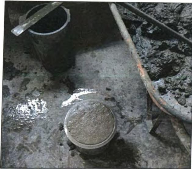
Figura A. 25. Muestra para el ensayo de contenido de aire.
