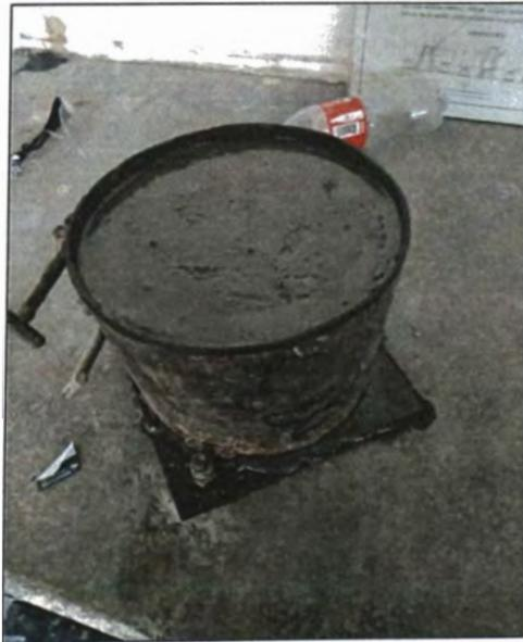
Figura A. 30. Muestra para el ensayo de tiempo de fragua.
