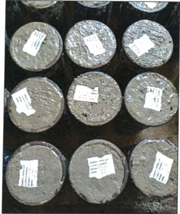
Figura A. 34. Probetas debidamente identificadas.
