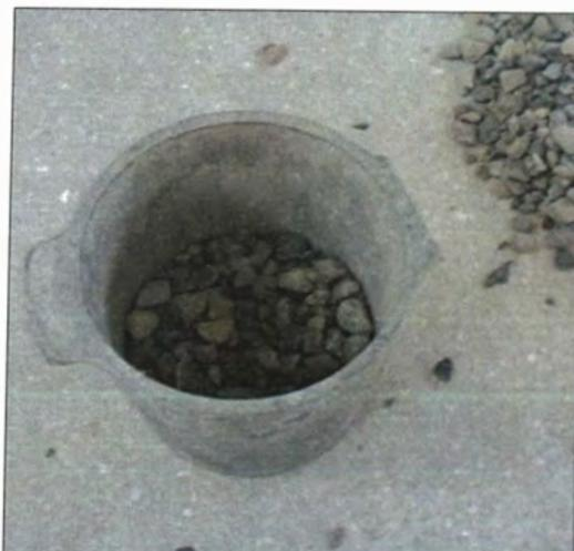
Figura A. 11. Ensayo de Peso Unitario del agregado grueso.
