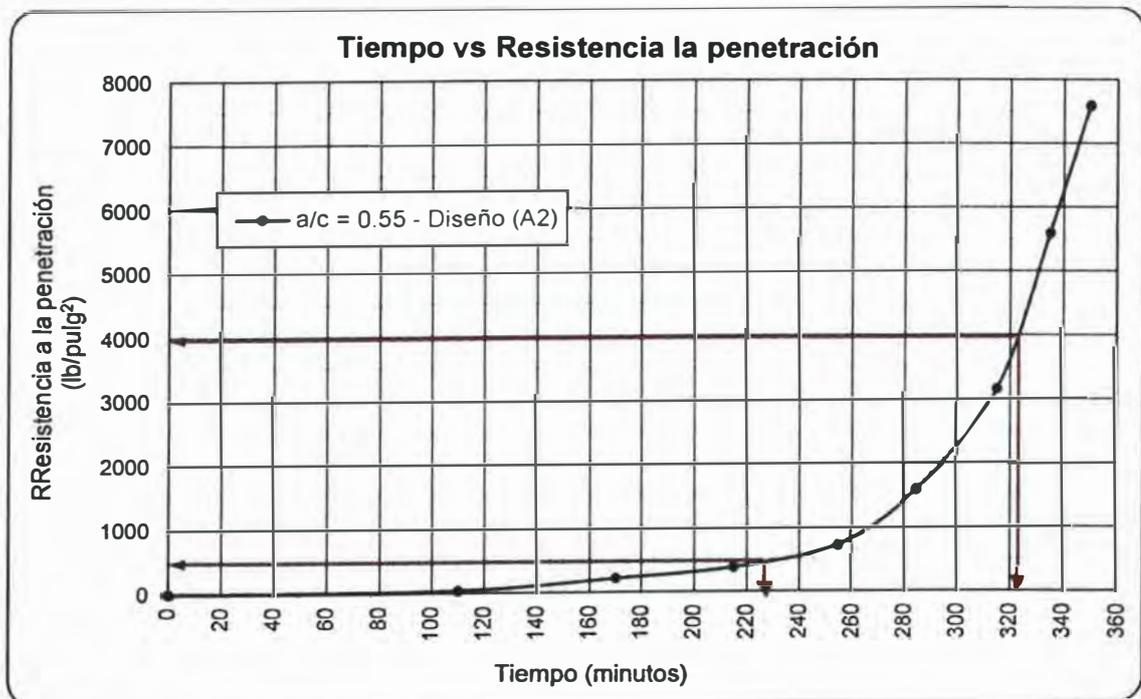
Figura N° VI.12. Tiempo vs Resistencia a la penetración, diseño (A2).
