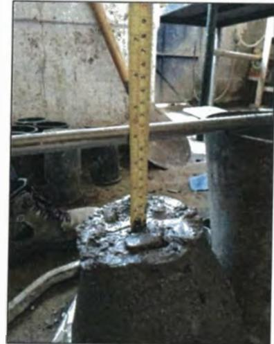
Figura A. 16. Medición del asentamiento.
