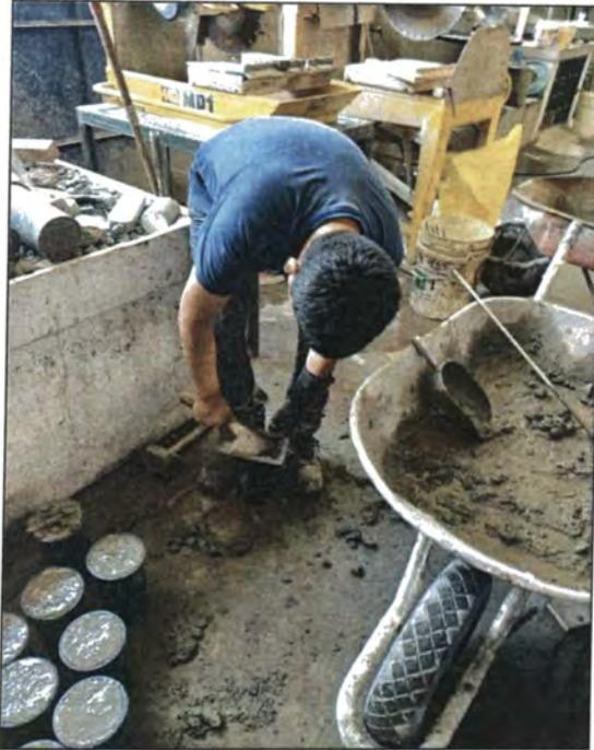
Figura A. 33. Elaboración de probetas.
