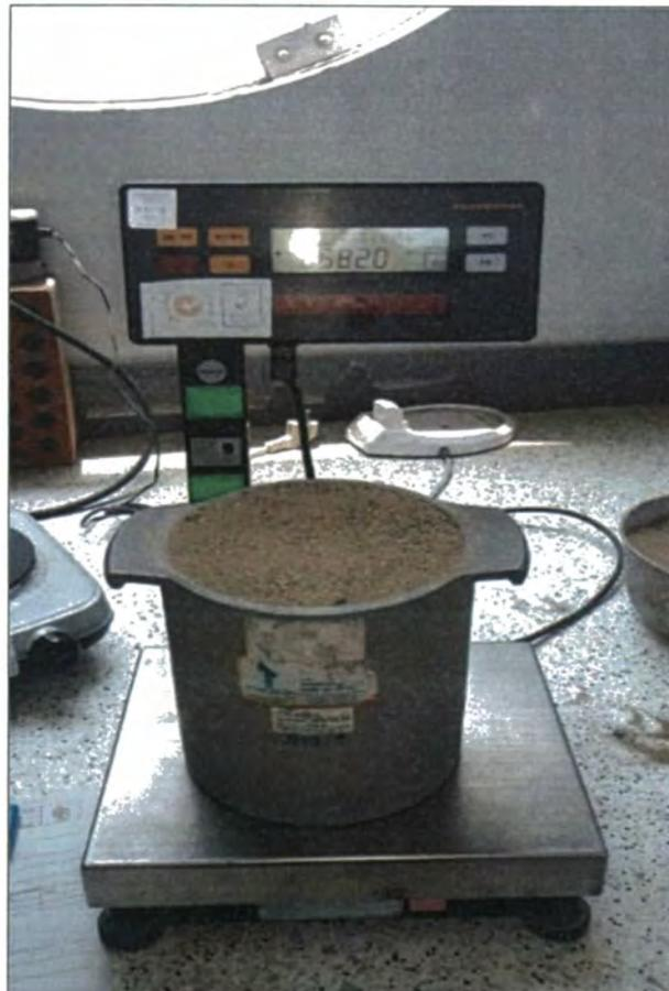
Figura N° III.10. Muestra Peso Unitario Compactado.
