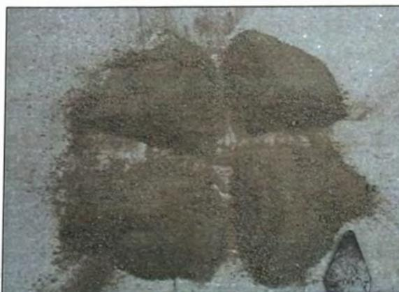
Figura A. 12. Cuarteo del agregado fino para realizar el ensayo de Peso Unitario.
