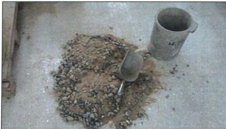
Figura N° III.7. Ensayo P.U.C. de la combinación de agregados.
