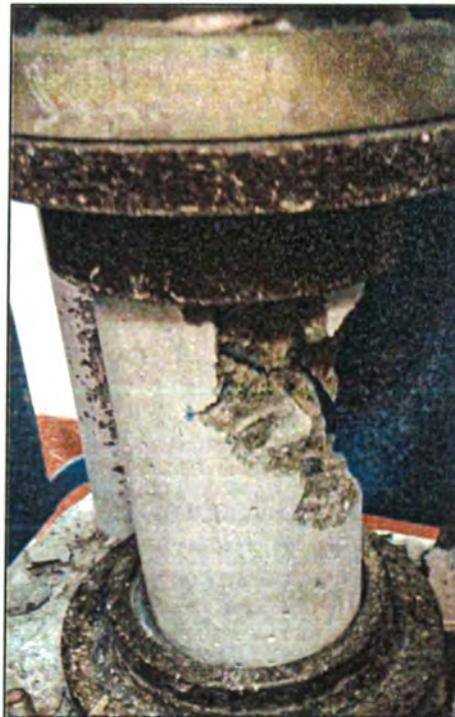
Figura N° V.4. Ensayo de compresión.
