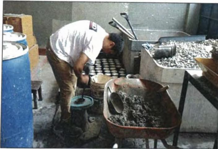
Figura A. 15. Ensayo de Cono de Abraham.
