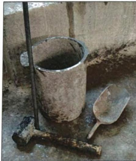
Figura A. 17. Equipo para la realización del ensayo de Peso unitario.
