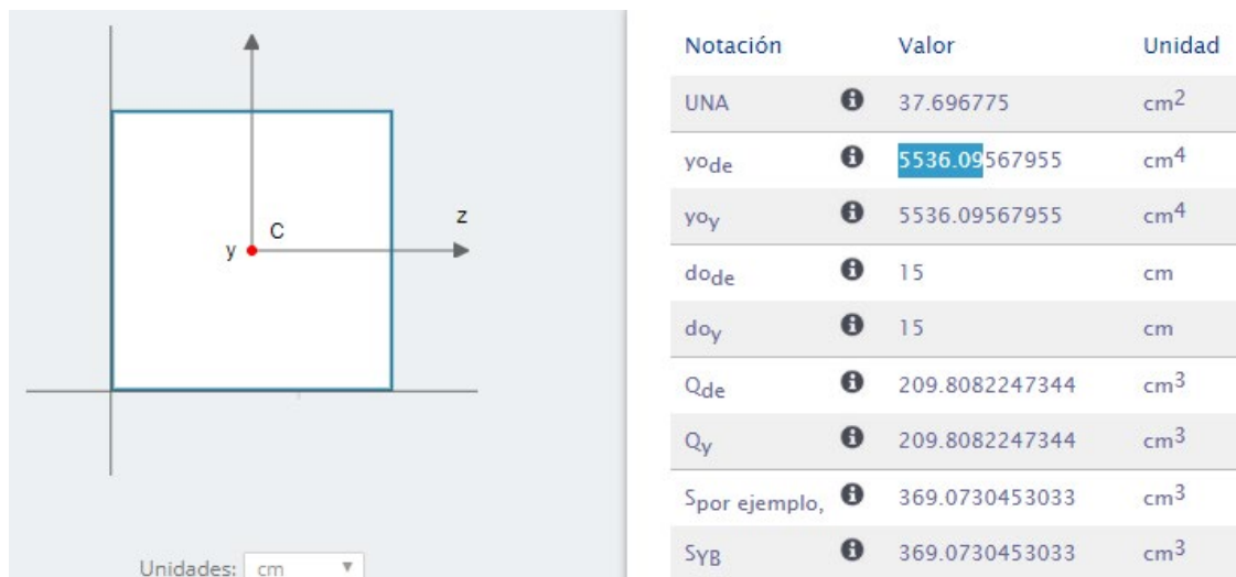
Figura 45. Momento de inercia de columna bx. Fuente: skyciv.com.
