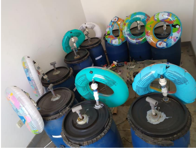
Imagen 5-5: Flotadores utilizados como recipientes de almacenamiento de biogás
