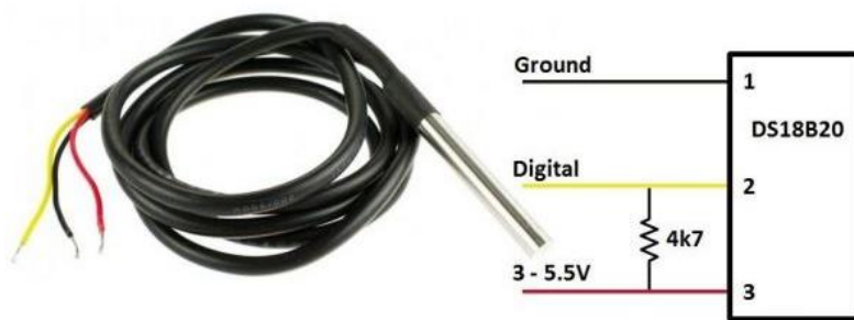
Imagen 3-1: Sensor DS18B20 y conexiones
