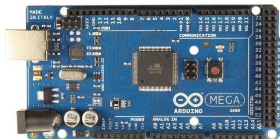
Imagen 2-3: Placa Arduino Mega 2560
