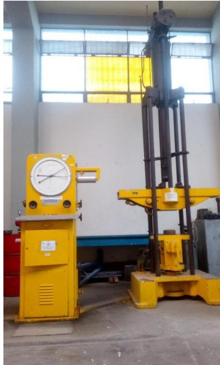
**Figura 21:** Maquina Universal AMSLER, 50 ton. de capacidad.
