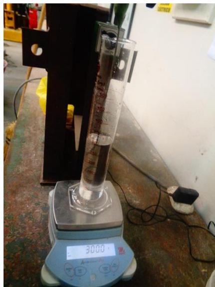
**Figura 41:** Peso del agua destilada en probeta graduada.
