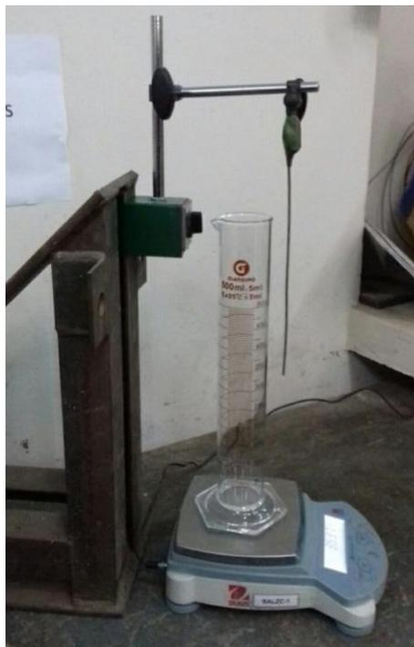
**Figura 39:** Balanza, Probeta, sujetador mecánico y alambre.
