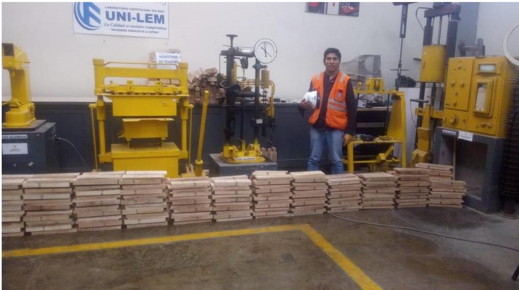
*Figura 30: Todas las probetas ensayadas, lado derecho de la imagen uniones con clavos de 2", al centro las de 2" 1/2 y al lado izquierdo las uniones de 3"*
