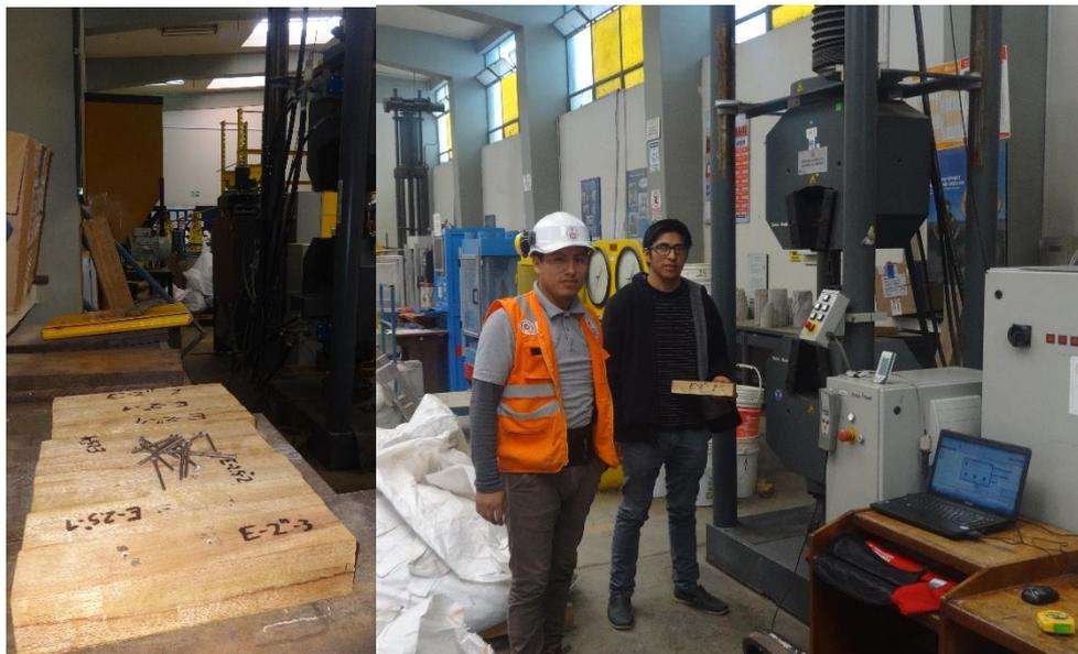
**Figura 49:** Probetas de extracción ensayadas para clavos de 2" y 2 ½"
