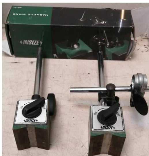
**Figura 25:** Sujetadores mecánicos con bloques magnéticos marca INZISE.
