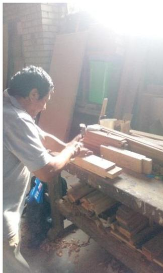
**Figura 19:** Armado y clavado de las uniones.
