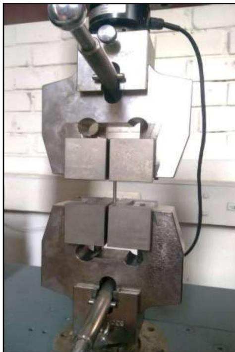
**Figura 43:** Máquina de tracción universal. ZWICK ROELL Z010
