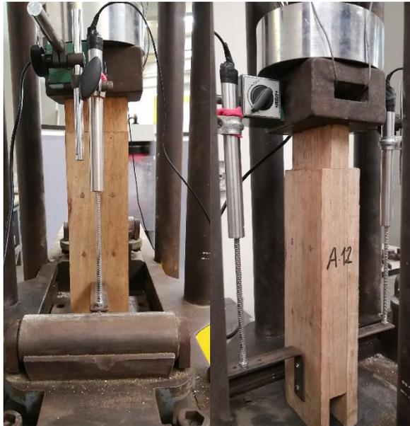
**Figura 28:** Aplicación de la carga de compresión paralela a las fibras en la probeta tipo A (Unión clavada de 2" de longitud del clavo).
