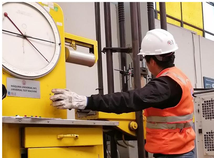
**Figura 27:** Regulación de la velocidad de la carga e inicio del ensayo de uniones clavadas.
