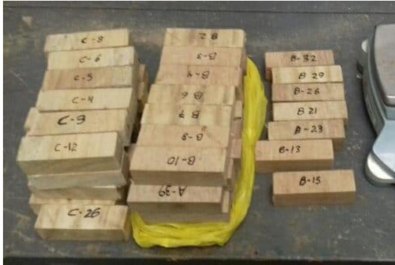
**Figura 36:** Muestras para medir el contenido de humedad.
