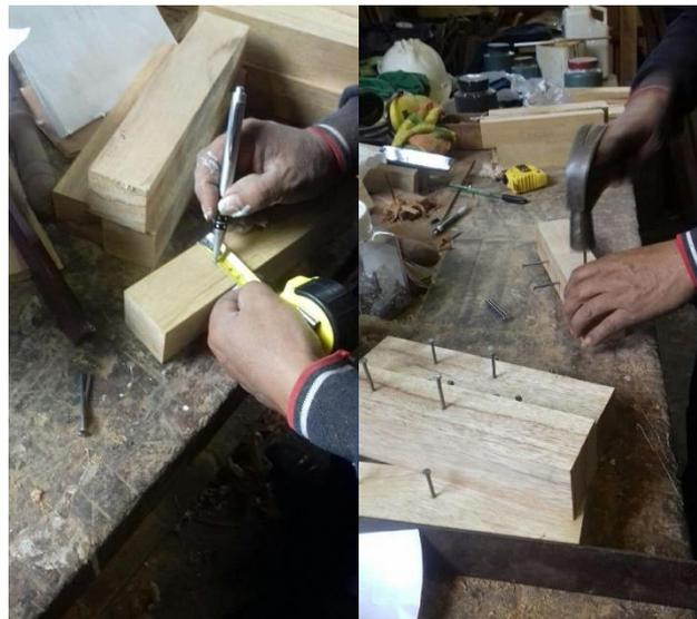
**Figura 47:** Elaboración de probetas para ensayo de extracción de clavos.
