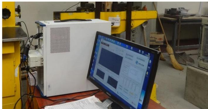
**Figura 22:** Computadora con sistema de adquisición de datos PXI/SCXI.
