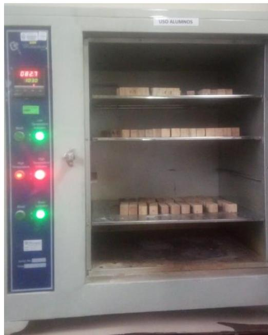
**Figura 38:** Secado de las muestras en el horno a 103 °C.
