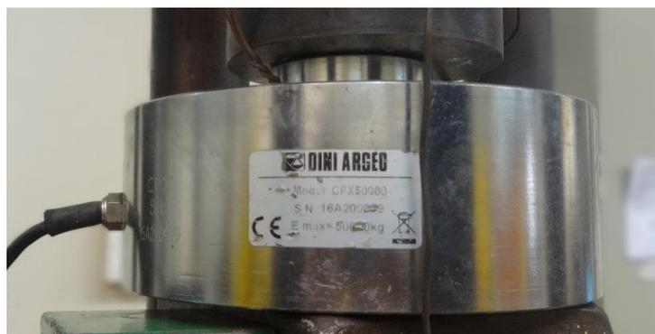
**Figura 23:** Sensor de compresión de carga, DINI ARCEO, 50 ton. de capacidad.
