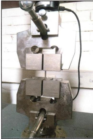
FIGURA N°2: FOTOGRAFÍA DE LA MUESTRA EN EL EQUIPO DE TRACCIÓN UNIVERSAL
