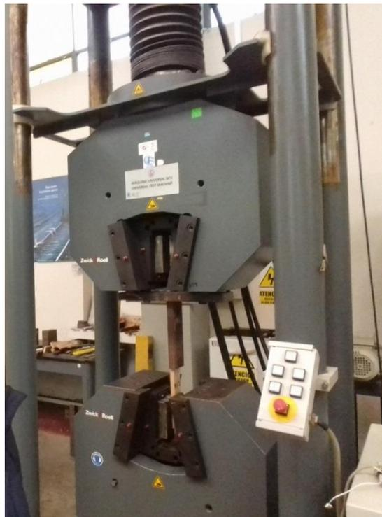
**Figura 45:** Máquina universal, marca Zwick Roell del LEM-UNI con 100 ton. de capacidad.
