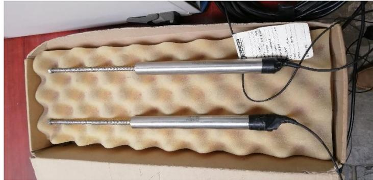
**Figura 24:** LVDT marca OMEGA, modelo LD320-50.
