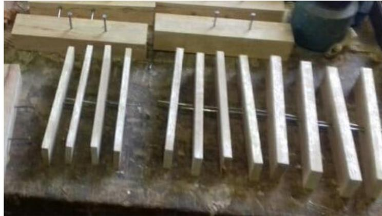
**Figura 44:** Probetas para ensayo de aplastamiento de distintos espesores: 10mm, 13mm y 15mm
