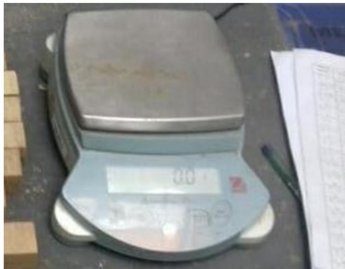
**Figura 35:** Balanza electrónica, OHAUS de precisión +/- 0.5 g.
