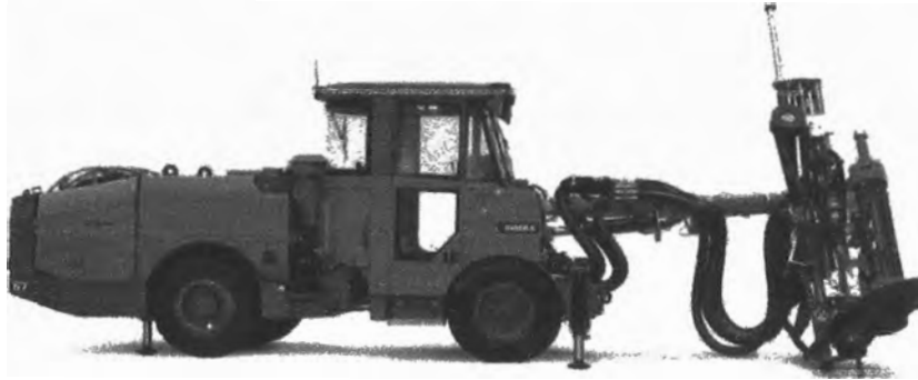
Equipo para perforación de taladros largos (Simba). Fuente: Epiroc. (2018). Simba S7
