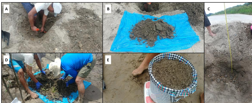
Figura 4.7. Muestreo de sedimento de los depósitos fluviales. Calicata manual. B: Acopio de muestra. C: Profundidad de la muestra aproximadamente 30 cm. D: Homogeneización de la muestra. E: Almacenamiento de la muestra.
