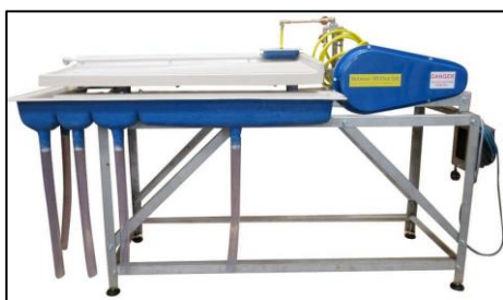
Figura 6.5. Mesa concentradora por vibración Wilfley.
