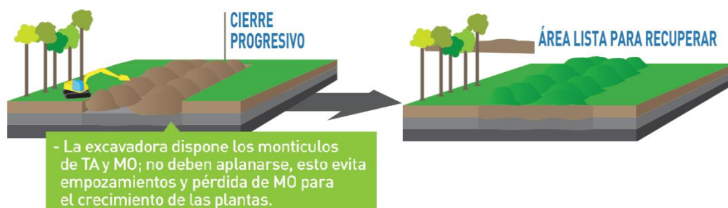
Figura 6.13. Esquema de relleno de terreno afectado por la actividad minera aurífera. Fuente: MINAM (2017)
