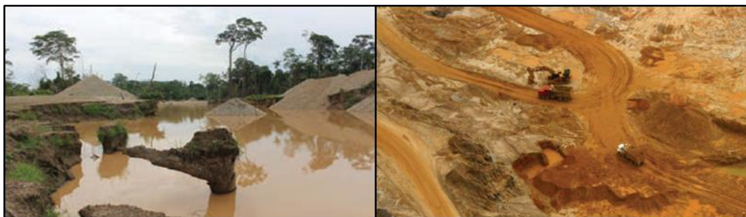
Figura 6.12. Cambios en el relieve por extracción de sedimentos. A la izquierda, agujeros por uso de bombas de succión. A la derecha, agujeros por el uso de maquinaria pesada. Fuente: MINAM (2017) y Brack et al. (2011).
