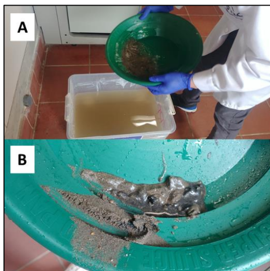
Figura 4.13. Proceso de concentración gravimétrica por bateo. A: Se muestra el zarandeo con agua para que las partículas pesadas se asienten al fondo de la batea. B: Se muestran arenas negras que corresponden a los minerales pesados concentrados.
